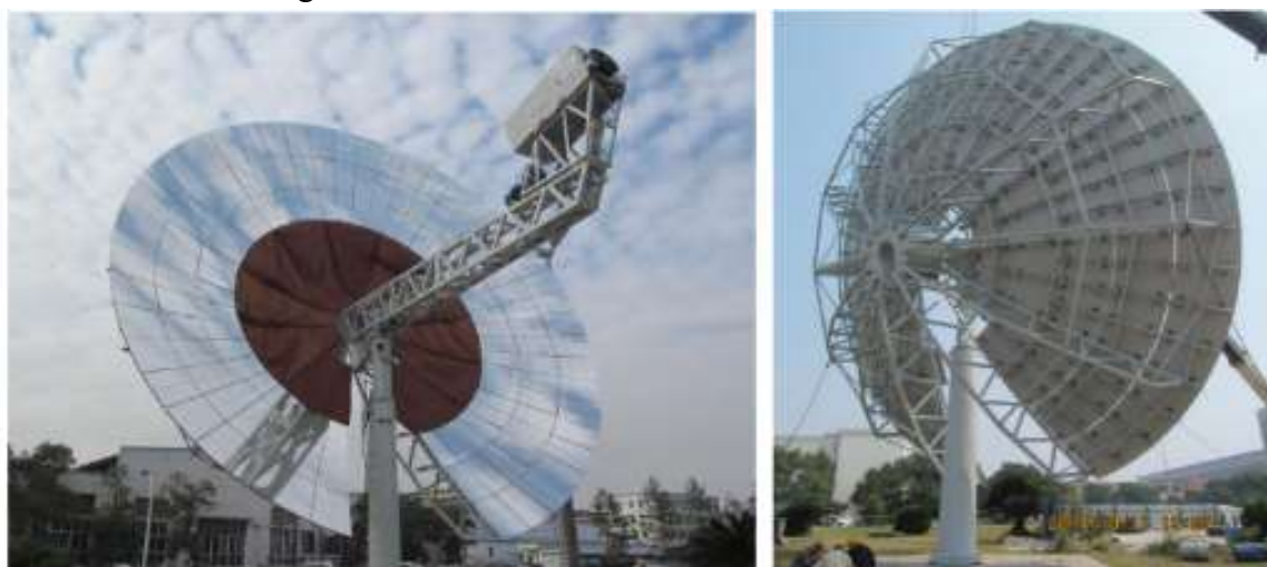
Figura 114: Concentrador de 38 kW DS-CSP - China
