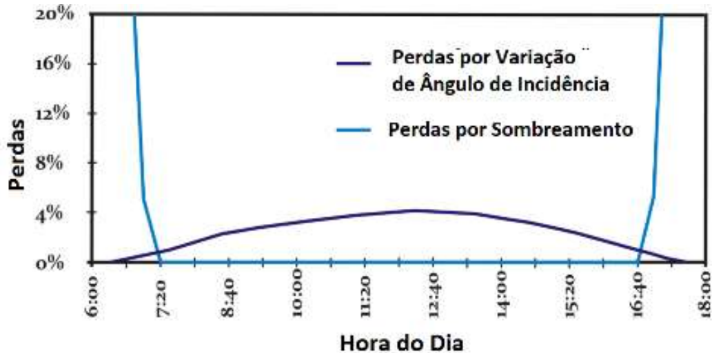
Figura 77: Perdas por sombreamento e por ângulo de incidência em coletor de calha parabólica
