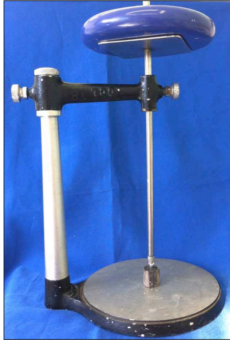
Figura 33 - Dispositivo adaptado para aplicação de pressão sobre o conjunto implante/pilar
