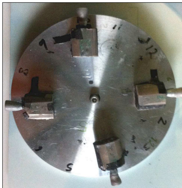
Figura 18 - Amostras posicionadas no porta-amostras do MEV
