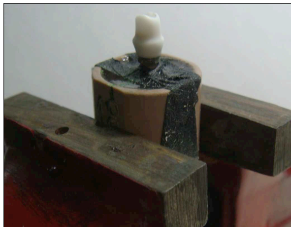
Figura 15 - Implante/pilar fixados em morsa de bancada
