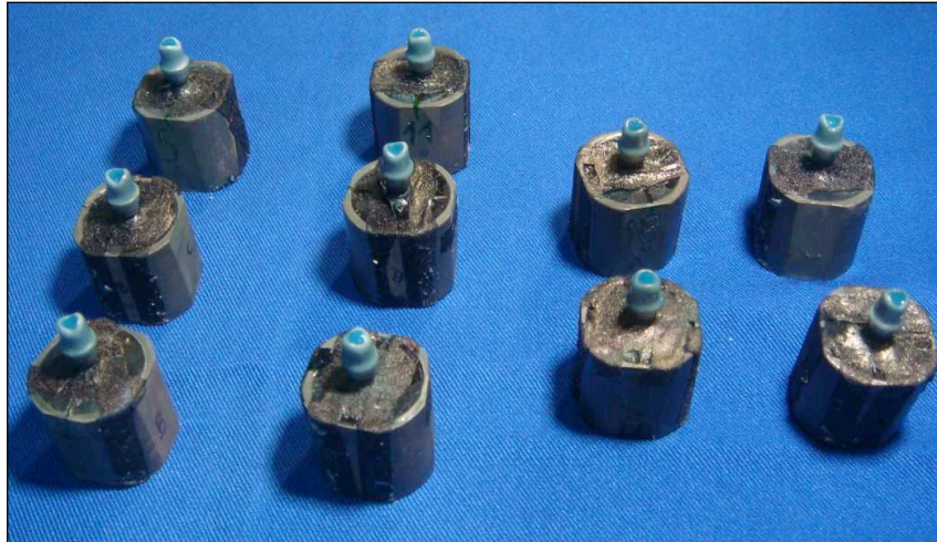
Figura 30 - Fechamento dos orifícios do pilar
