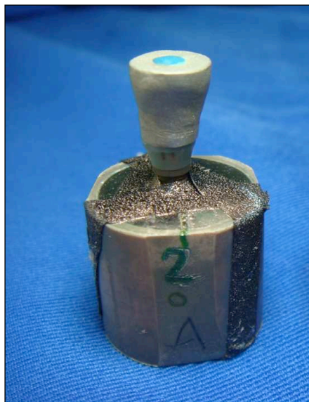
Figura 29 - Coroa Cr-Co em posição sobre o pilar
