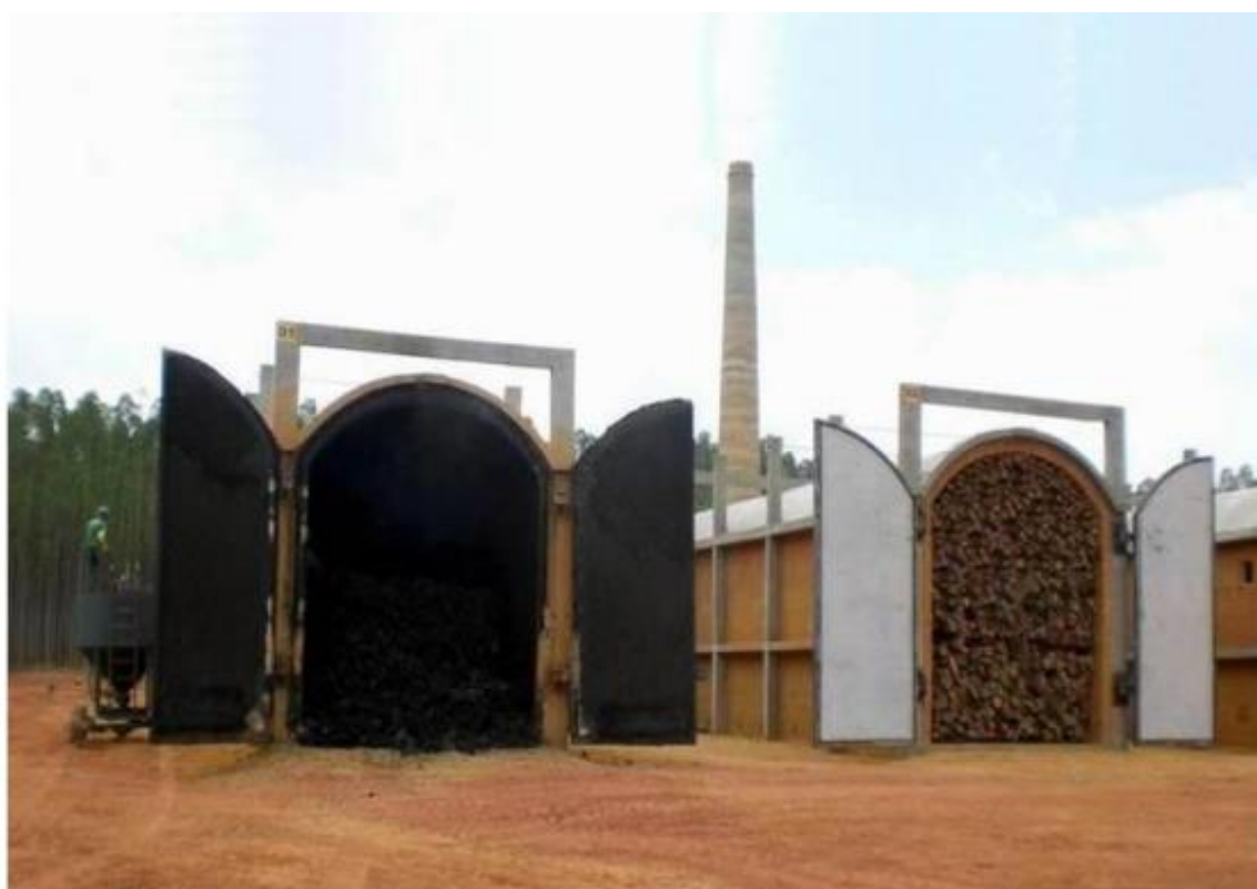
Figura 11: Fornos de Carbonização Retangulares Fonte: Viena Siderúrgica (2019).
