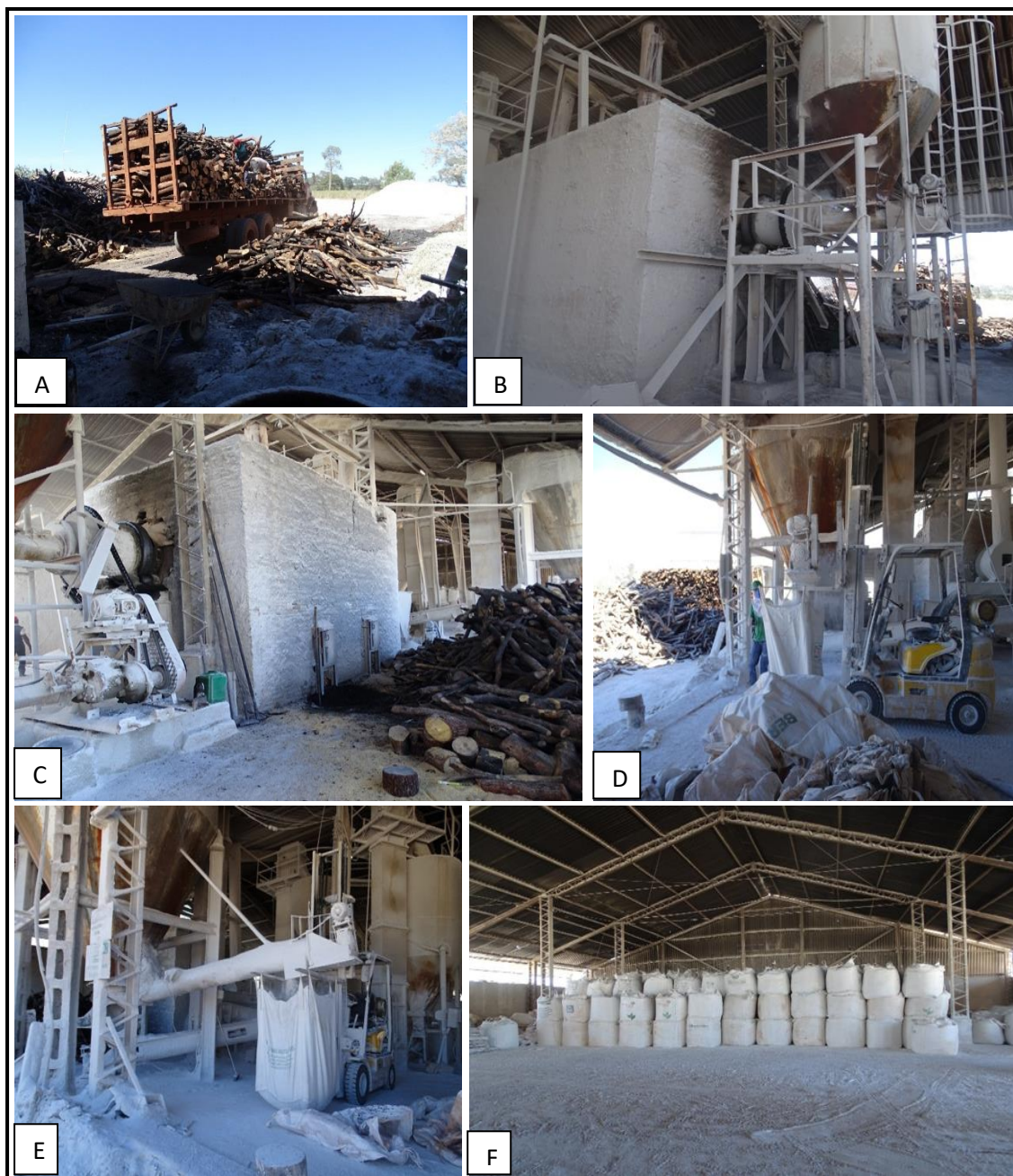
Figura 5 – Etapas do processo de calcinação no polo gessoiro de Grajaú (MA)
