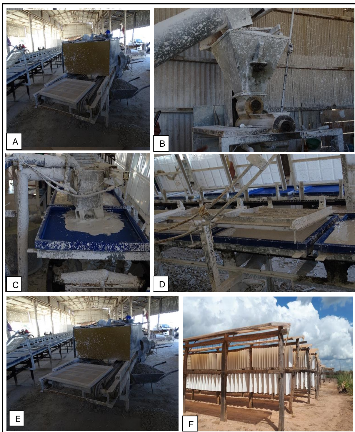
Figura 7 - Fabricação de placas de gesso parcialmente mecanizada Fonte: Pesquisa de campo (2019)
