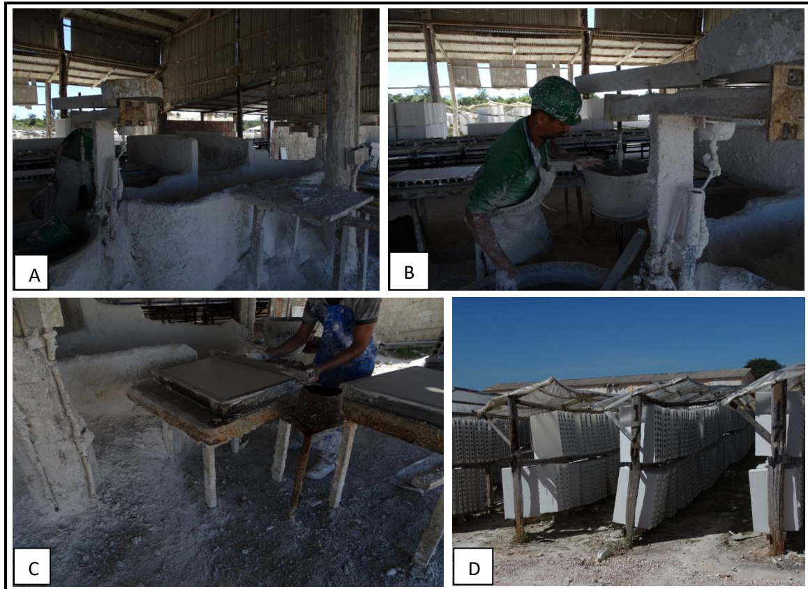
Figura 8 - Fabricação de blocos para divisória Fonte: Pesquisa de campo (2019)
