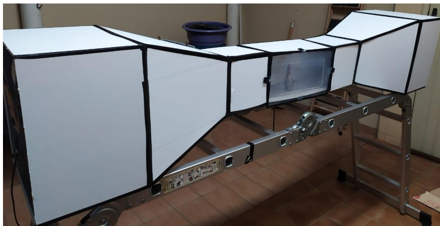
Figura 14 – O Túnel de Vento completo.
