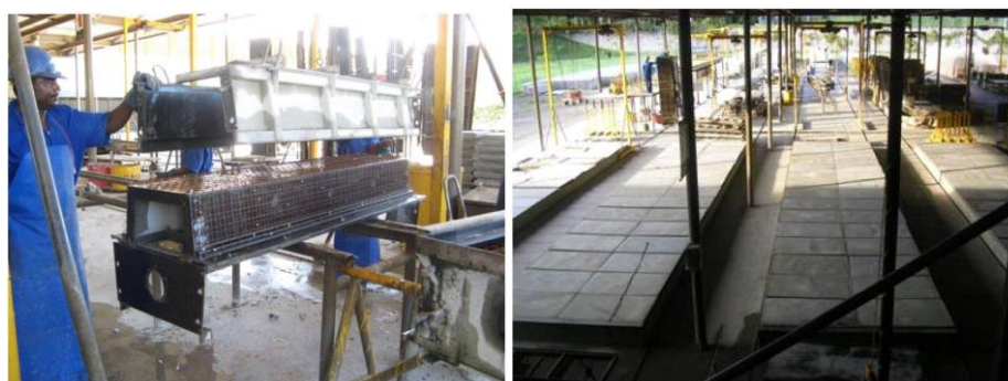
Figura 6 - Preparação da Forma e Figura 7 - Tanque de Cura Fonte:TRIGO, 2009.
