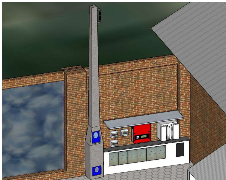
Figura 33 - Componentes para geração de energia através do sol, inversor, transformador, DPS e disjuntores, Fonte: Autoral
