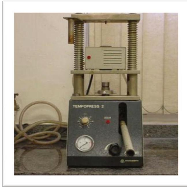
Figura 1 – Termo-plastificador (Termopress 2): embutimento a quente de materiais
