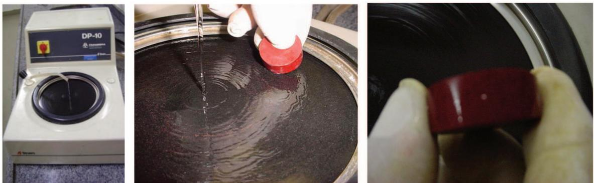
Figura 3 – Polimatriz automática: realização do acabamento e polimento das amostras
