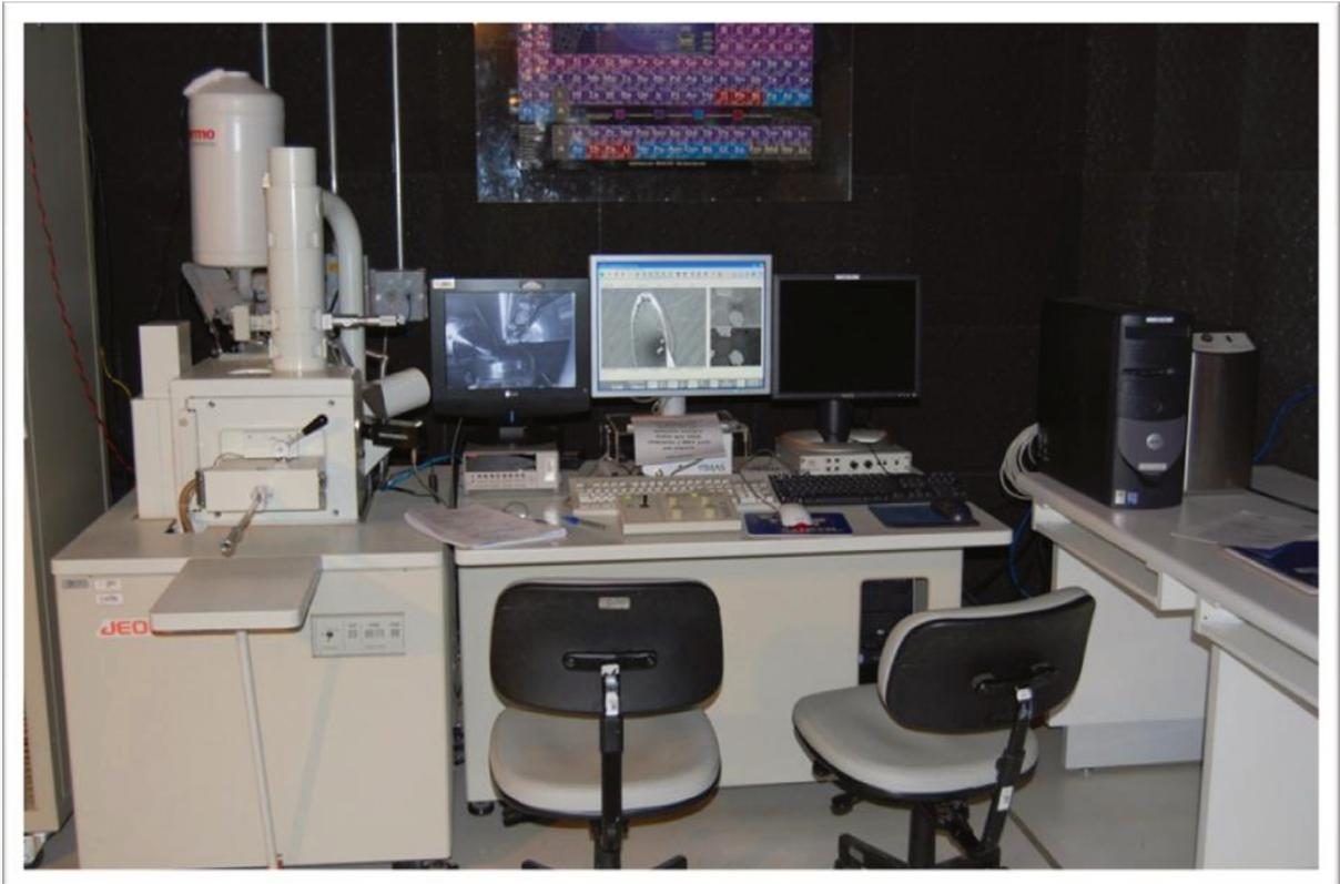
Figura 10 – Microscópio Eletrônico de Varredura: SEM-LV JSM 5900 (CNPEM/Campinas - São Paulo – Brasil)
