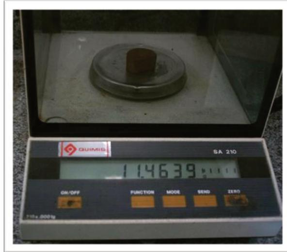
Figura 6 – Balança analítica digital: pesagem das amostras após preparo cervical
