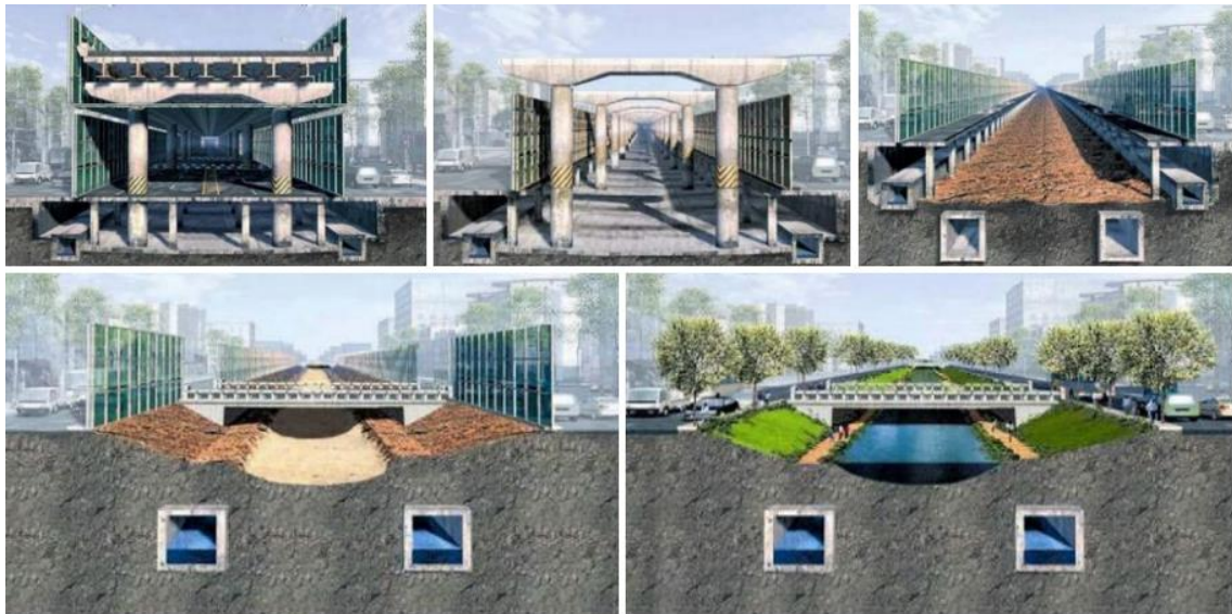
Figura 10 – Etapas do destamponamento do córrego.
