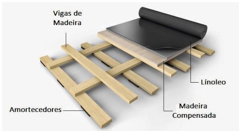
Figura 34 - Piso de madeira
