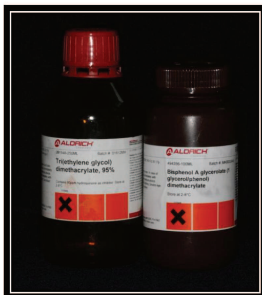
Figura 5 - Matriz Orgânica dos cimentos resinosos experimentais (Bisfenol glicidil dimetacrilato – BisGMA ; Trietileno glicol dimetacrilato – TEGDMA)
