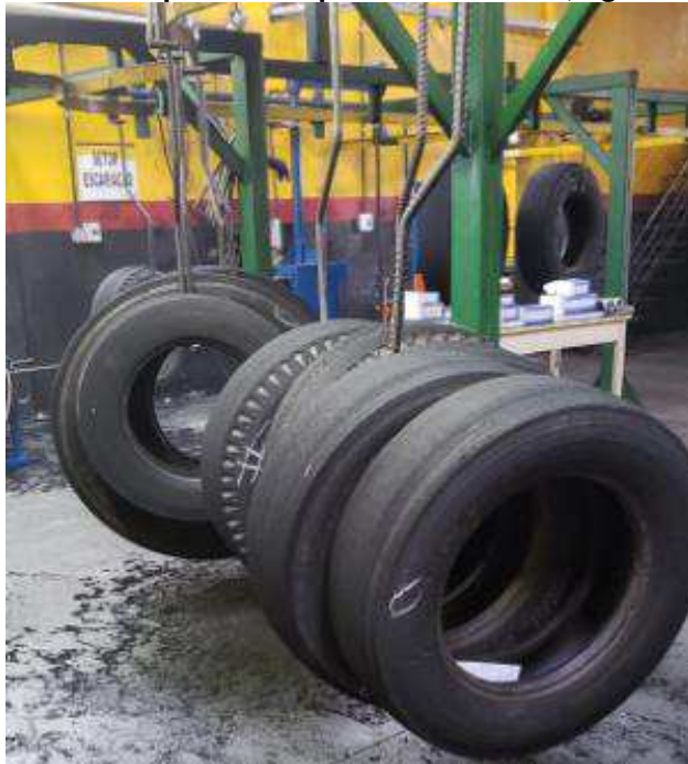
Figura 14 – Pneu na gancheira depois de raspado e escareado, aguardando o conserto
