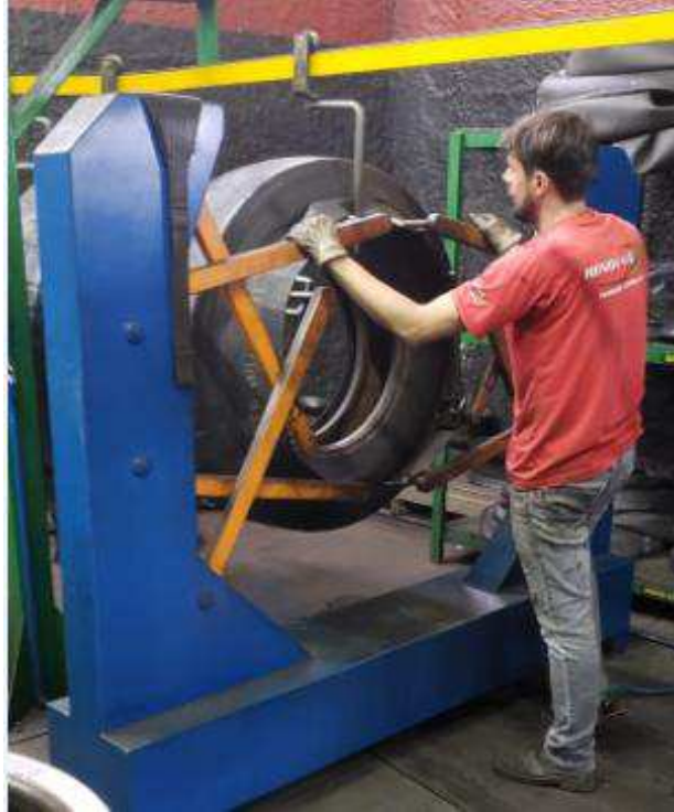
Figura 17 - Pneu sendo preparado para vulcanização
