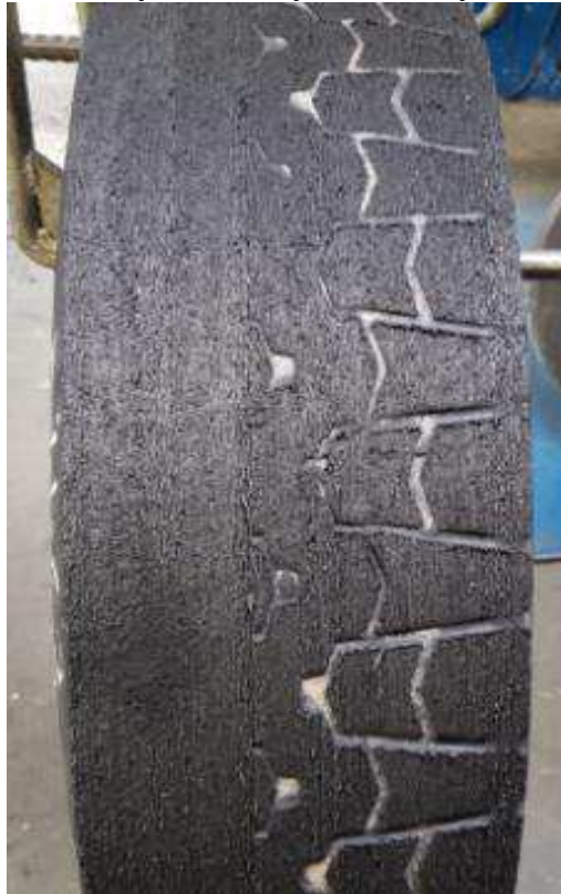
Figura 13 – Pneu raspado, com parte ainda por receber a raspa
