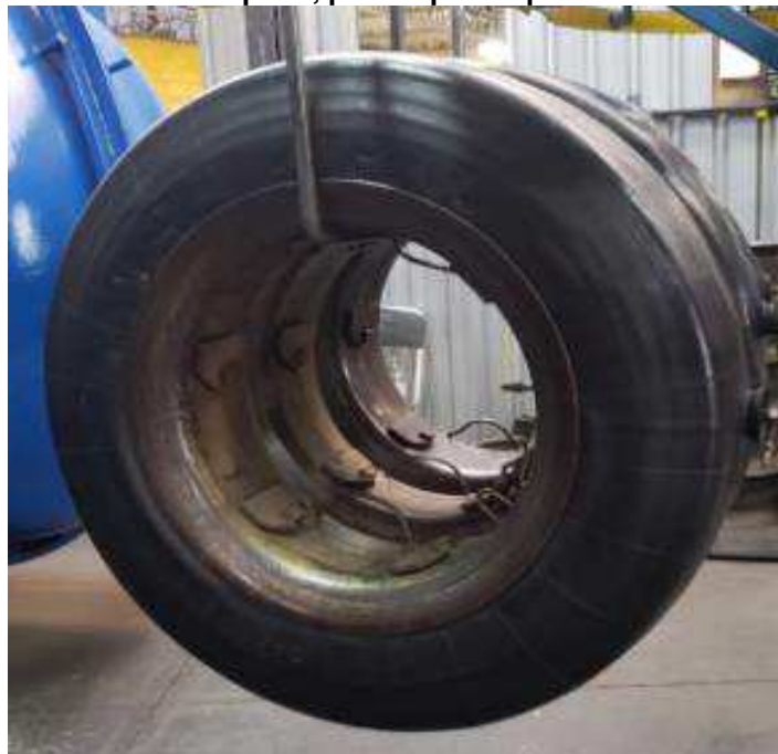
Figura 18 - Pneu envelopado, pronto para o processo de vulcanização
