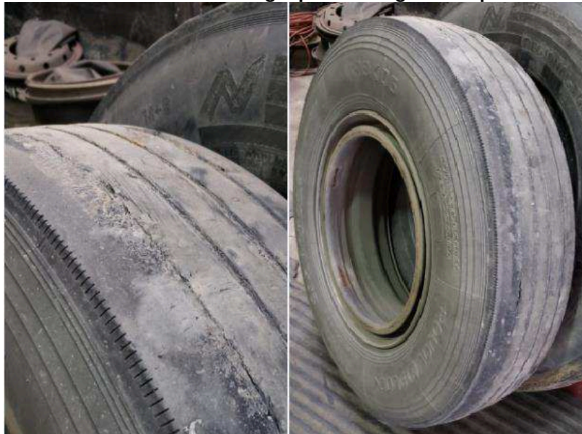
Figura 12 – Pneus desmontados logo quando chegam à empresa Alfa
