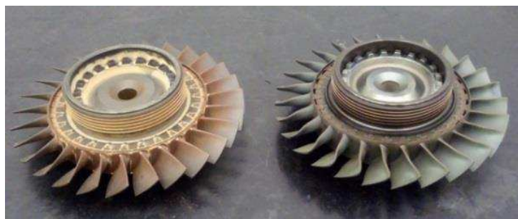
Figura 13: Turbinas pré e pós aplicação da TU 347
