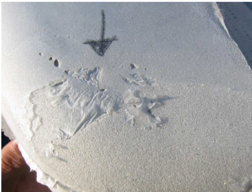
Figura 37 - Falha de temperatura do molde incorreta
