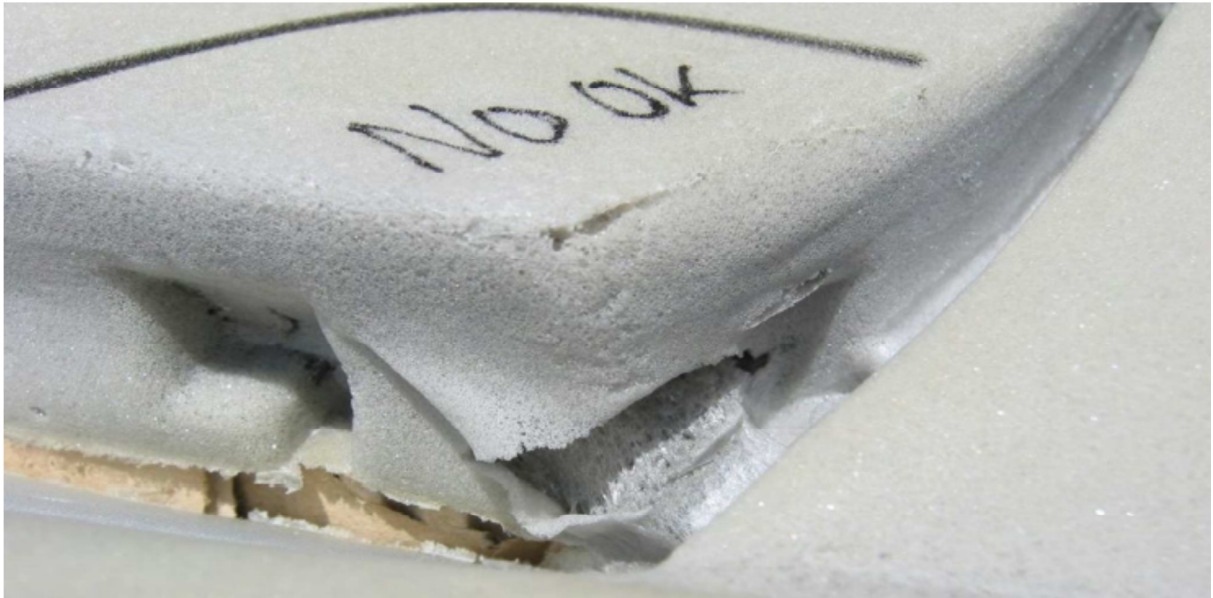
Figura 32 - Falha de Colapso
