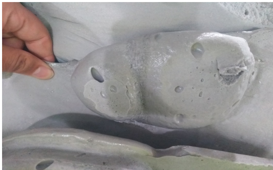
Figura 26 - Peça com falha de injeção por falta de expansão do material
