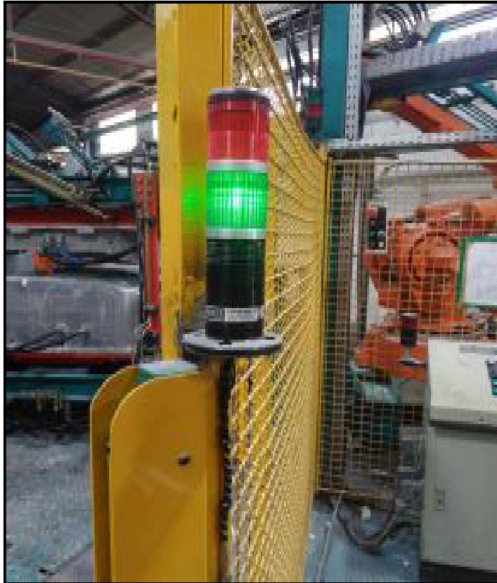
Figura 30 - Sinal para visualizar processo em operação
