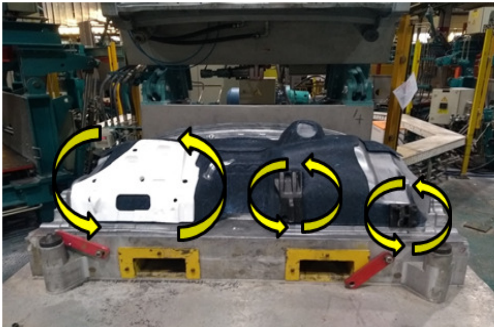
Figura 27 - Componentes posicionados sobre o molde
