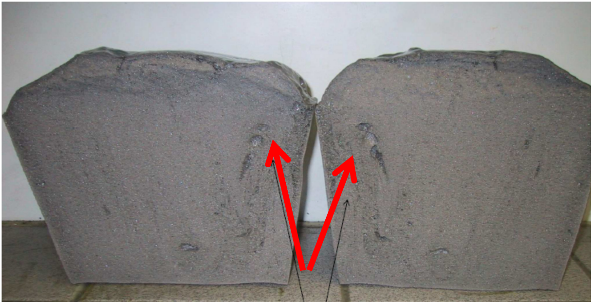
Figura 35 - Falha de mistura insuficiente
