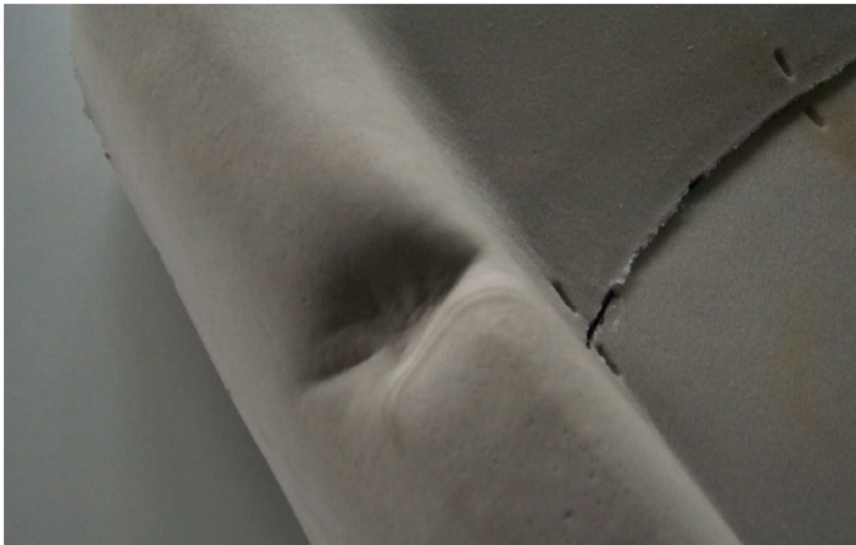
Figura 36 - Falha de marca, deformação e rasgo
