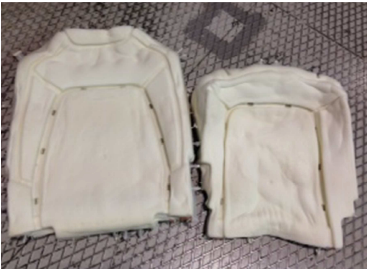
Figura 33 - Falha de encolhimento
