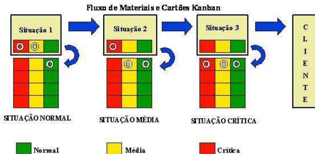
**Figura 9** – Mecanismo de funcionamento do Kanban
