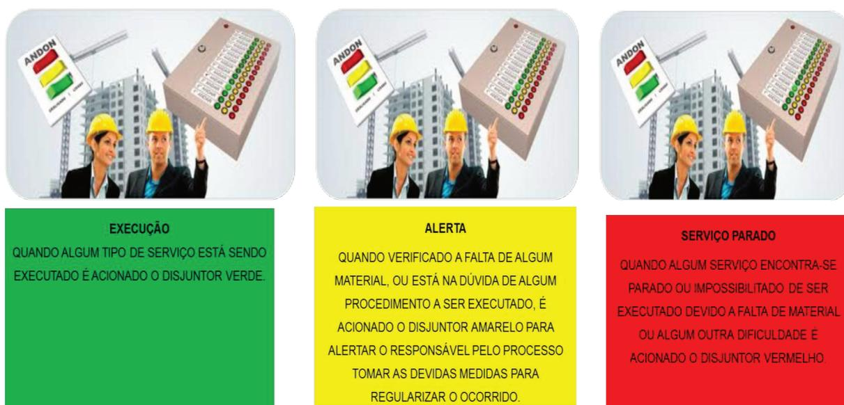
**Figura 8 – Sistema Andon na Construção Civil**
