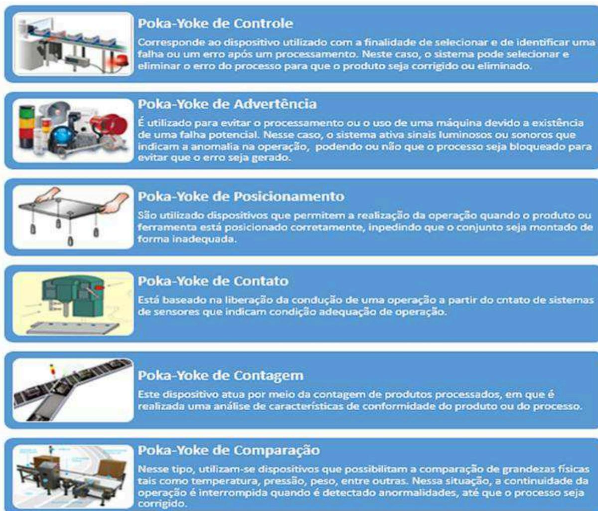
**Figura 14** – Sensores do Sistema Poka-Yoke
