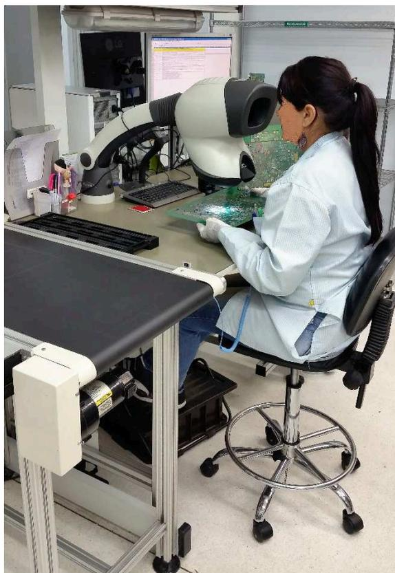
**Figura 5 - Inspeção visual, por meio de um microscópio**
