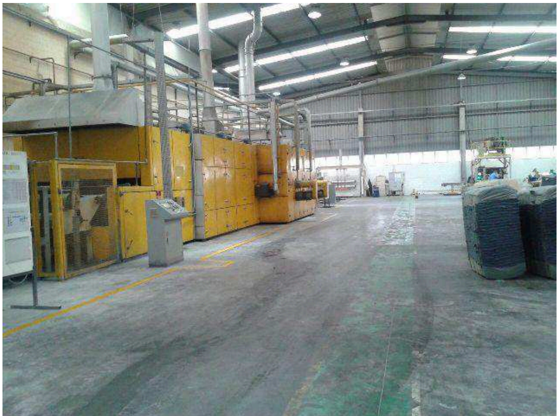
Figura 05- Feilong Felt Line – Modelo da máquina instalada na manufatura de feltro
