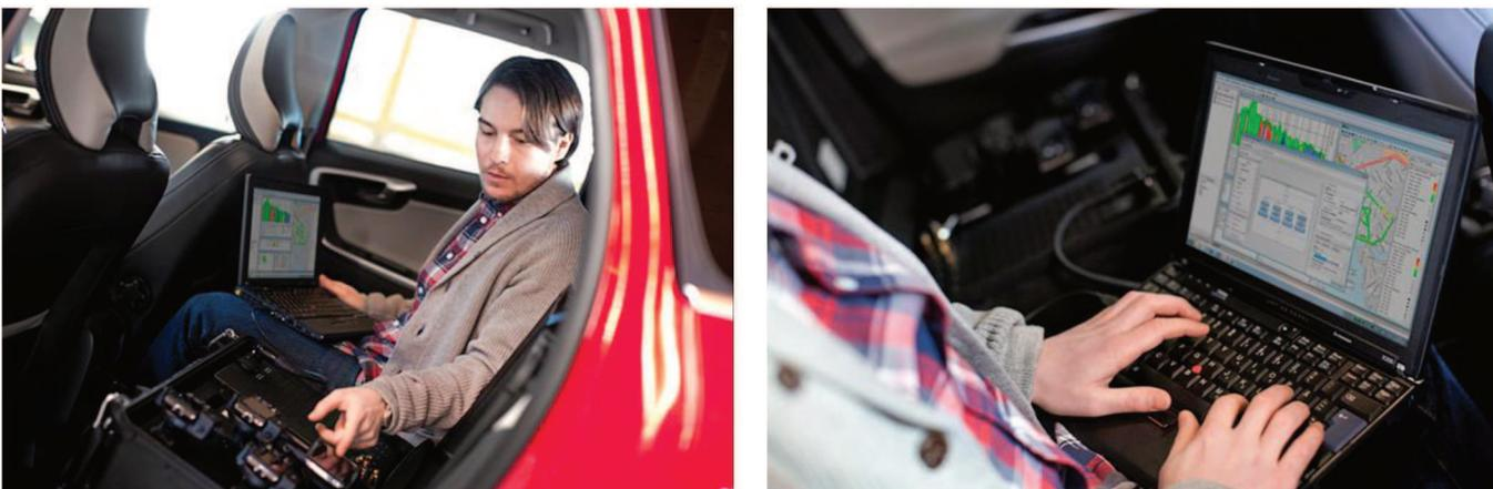
*Figura 11 – Equipamentos usados para drive test (Fonte: Ascom Networks)*
