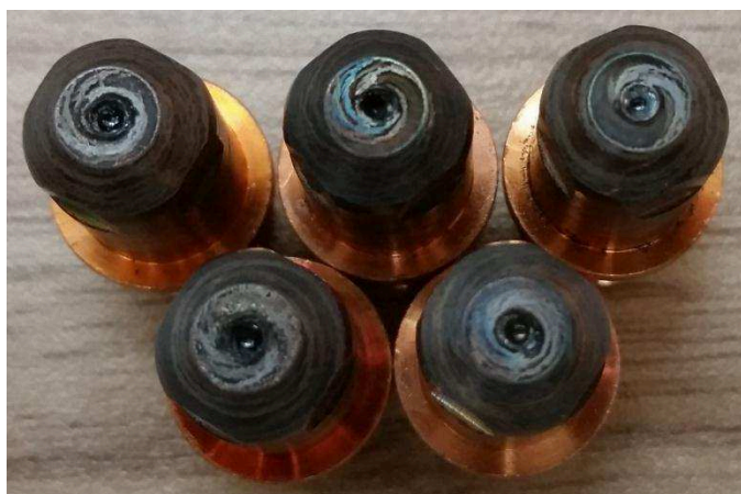
Figura 17 - Exemplos de bicos de corte desgastados, tendo a saída do arco de Plasma comprometida e irregular.
