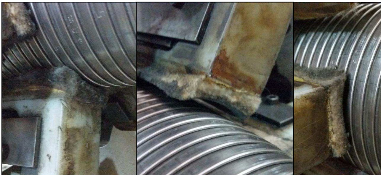
Figura 23 – A imagem mostra as garras que seguram as mangueiras já com o material trocado e em funcionamento.
