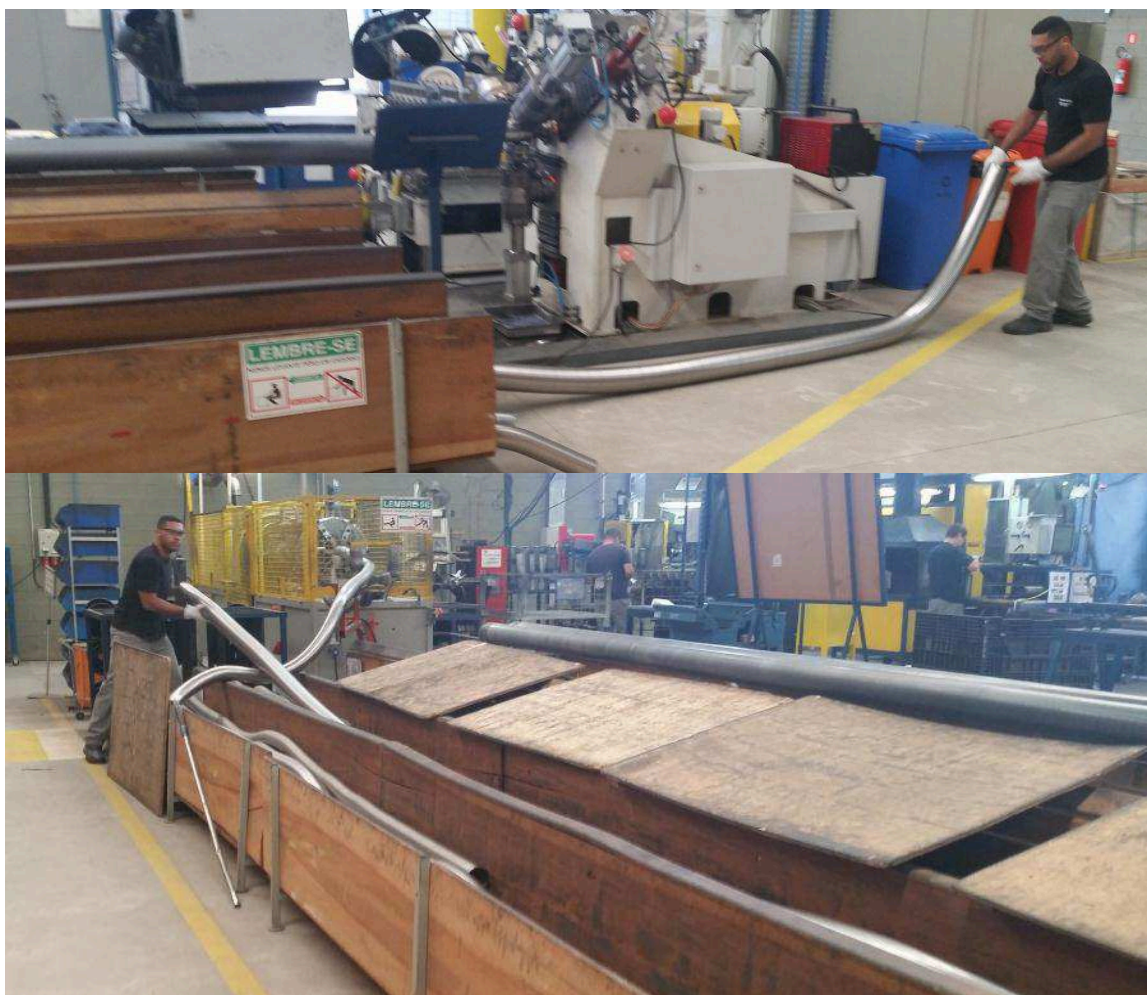
Figura 20 - A imagem mostra um operador devidamente treinado realizando a operação de movimentação da mangueira de maneira correta.
