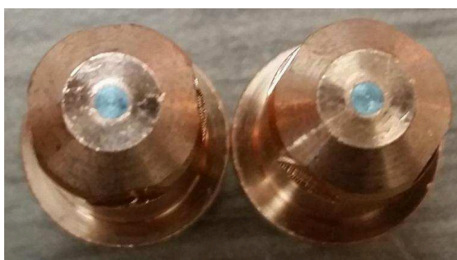
Figura 18 - Exemplos de bicos de corte em bom estado.
