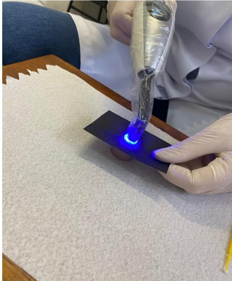
Figura 2. Processo de Polimerização das amostras, com barreira para a luz focar em apenas um lugar específico.
