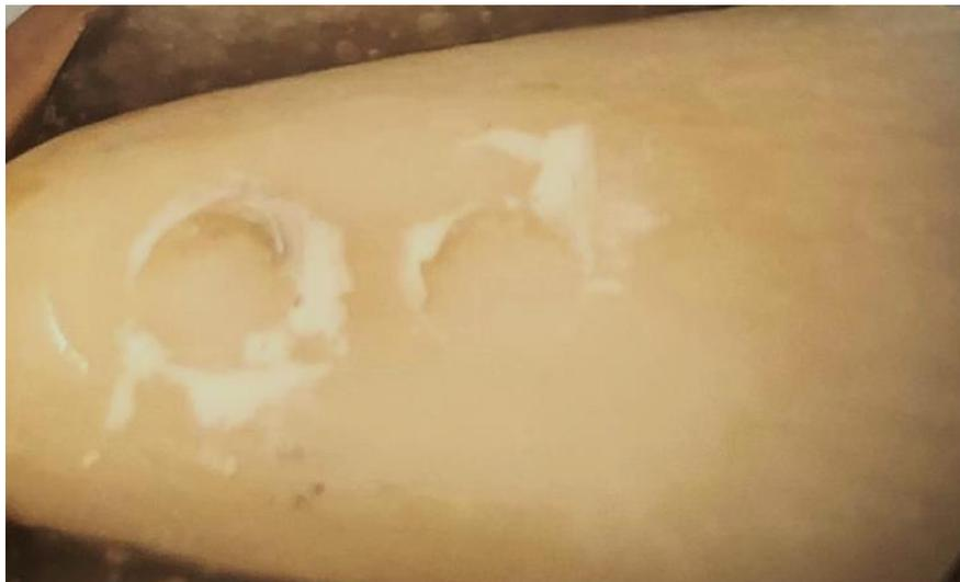
Figura 5. Amostra após teste de resistência adesiva ao cisalhamento; exemplo de falha adesiva.
