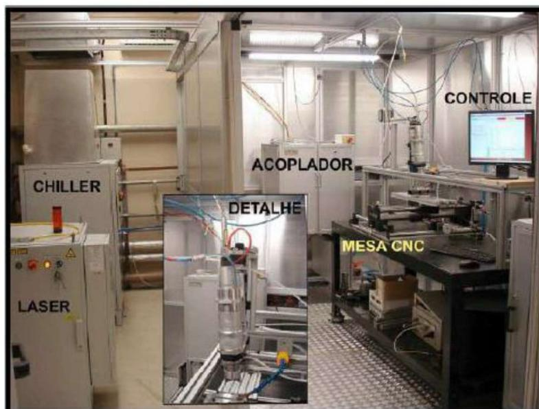
**Figura 13** - Equipamento de Solda a Laser, com detalhe do cabeçote de Soldagem (CAPELLA, 2011)
