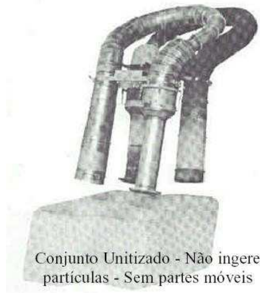
Figura 15 – Hiller Pulse Reactor S/VTOL Lift Engine MODELO HH 5.25 – 7. Conjunto auxiliar para decolagem composto por um par de turbinas (1967)
