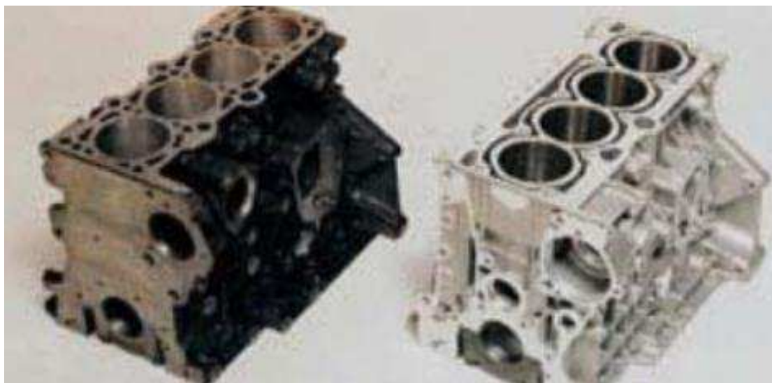
Figura 12 Bloco de motor de ferro fundido e bloco de motor de alumínio
