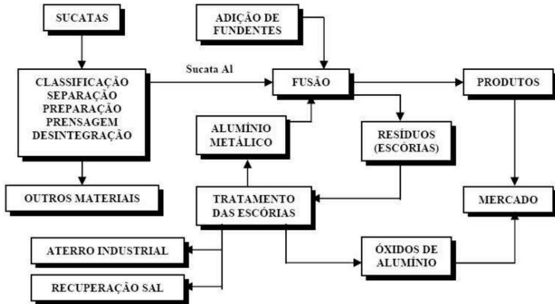
Figura 4 - Fluxo de operação industrial do alumínio secundário
