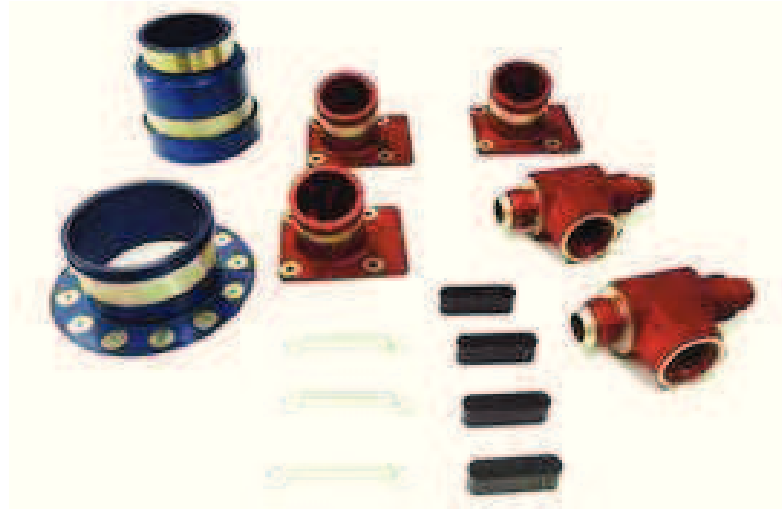
Figura (1) - Peças anodizadas em meio sulfuroso e pigmentadas
