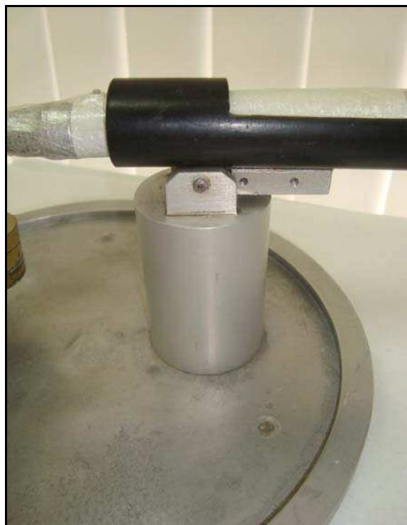
Figura 5 – Cilindro confeccionado para suportar a peça reta e o contra-ângulo redutor
