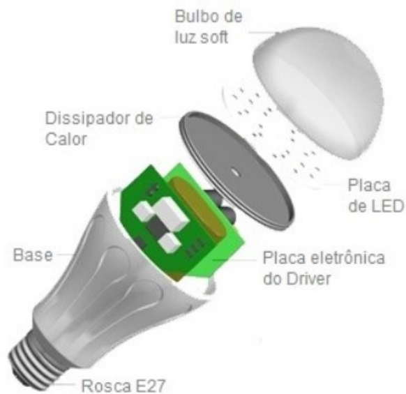
Figura 14 - Composição de uma lâmpada LED
