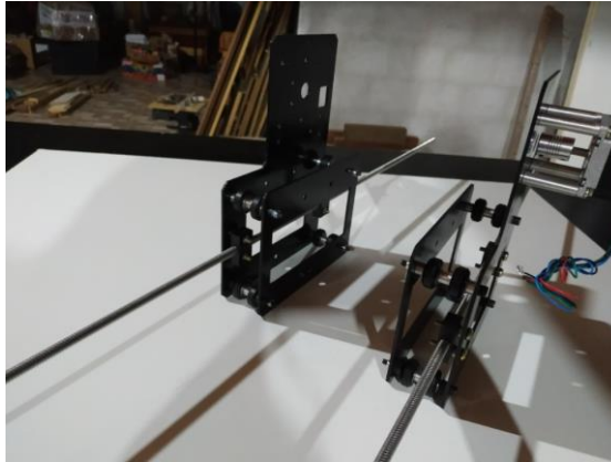
Figura 43: Montagem dos fusos trapezoidais no eixo Y
