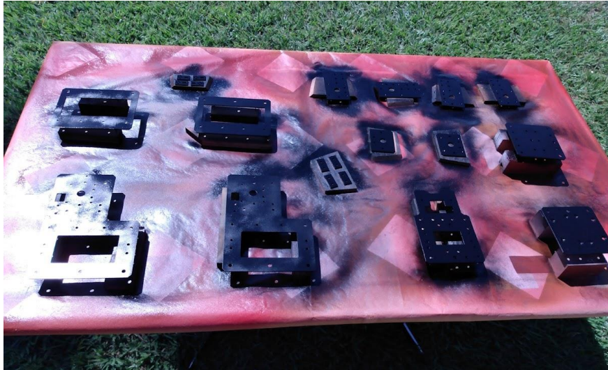
Figura 37: Pintura das placas de aço carbono
