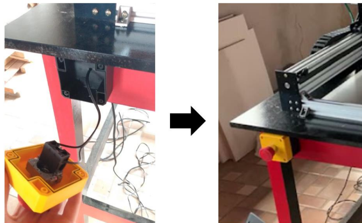
Figura 62: Botão de emergência
