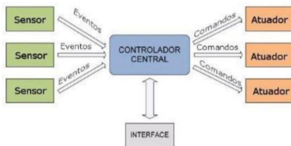
Figura 2 - Arquitetura Centralizada dos Equipamentos
