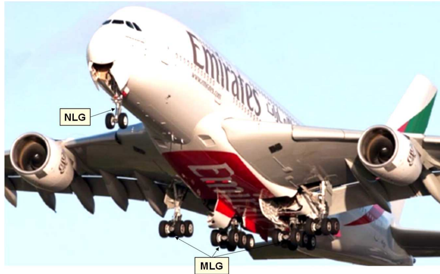
Figura 16 – Trens de pouso de um A380. Notar os dois tipos (modelos) de trem de pouso, o principal (MLG) e o auxiliar (NLG) Fonte: Adaptado de Bulté (2020).
