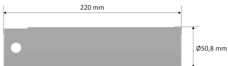
Figura 31 – Dimensões do pino pivô do trem de pouso de aeronave construídos via manufatura subtrativa
