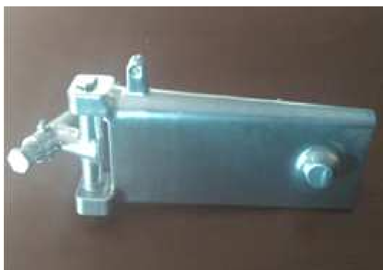
Figura 43 – Protótipo em MA do trem de pouso de aeronave integrado e com perfil aerodinâmico Fonte: Próprio Autor (2020)
