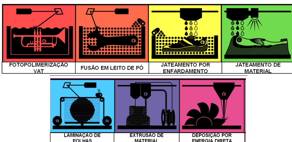
Figura 10 – Técnicas e processos de MA estabelecidos na ASTM F42 Fonte: Adaptado de Hybrid Manufacturing Technologies (2020).
