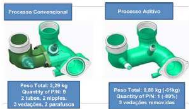
Figura 8 - Comparação entre manufatura subtrativa (A) e manufatura aditiva (B)
