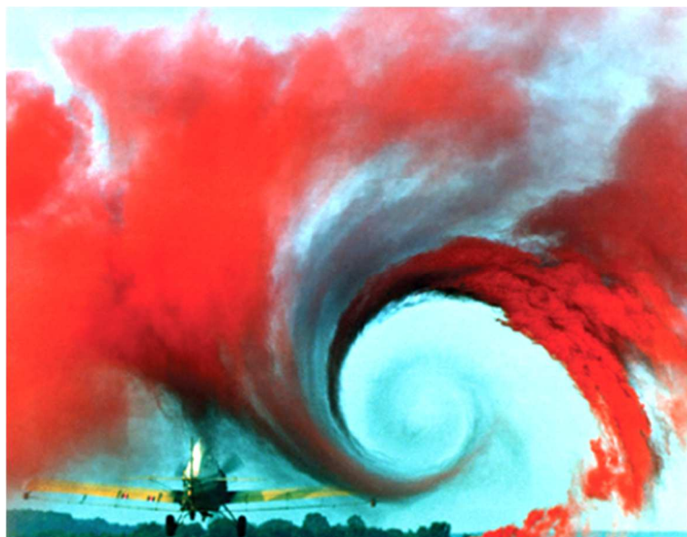
Figura 22 – Efeito do arrasto aerodinâmico induzido por uma aeronave Fonte: Adaptado de FAA Pilot's Handbook (2008).
