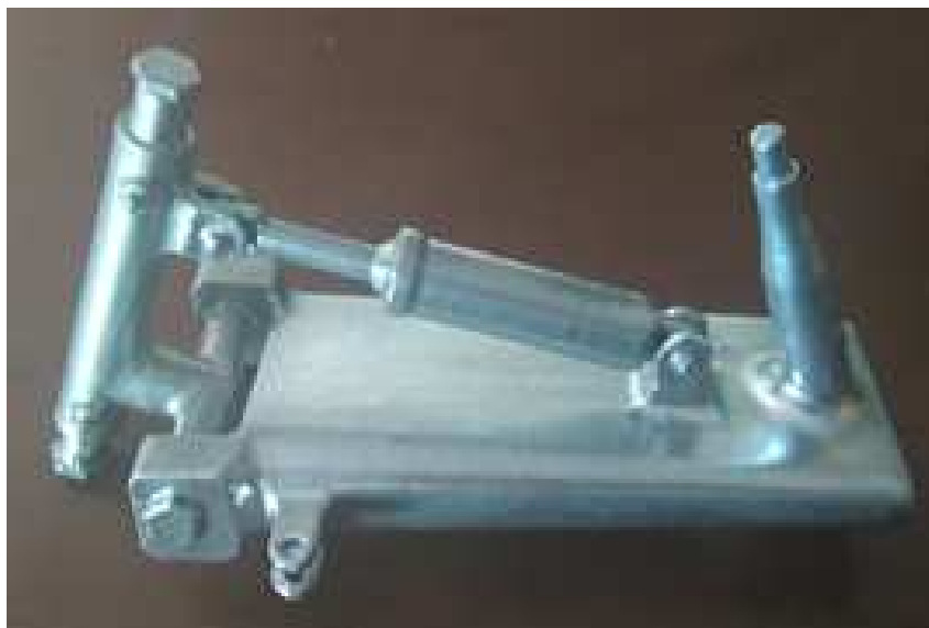
Figura 44 – Protótipo em MA do trem de pouso de aeronave integrado e com perfil aerodinâmico Fonte: Próprio Autor (2020)
