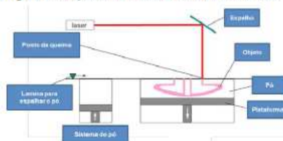
Figura 1 – Esquema de funcionamento da técnica SLM
