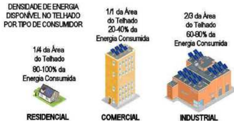
Figura 7. Esquema mostrando visualmente a relação entre a área disponível do telhado de consumidores (residenciais, comerciais e industriais) com relação ao atendimento de energia elétrica consumida. Próprio Autor.
