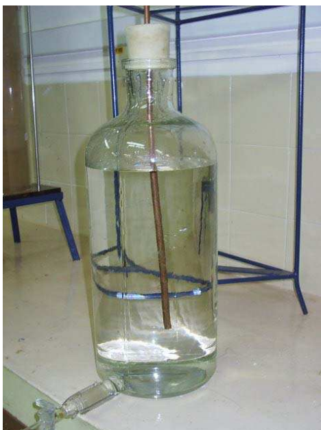
Figura 2 – Frasco de Mariotte com saída para a coluna na parte inferior
