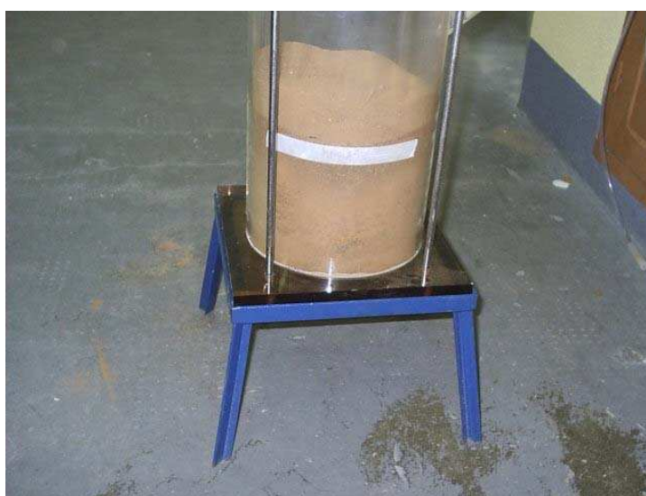
Figura 3 – Coluna de acrílico sobre o suporte metálico
