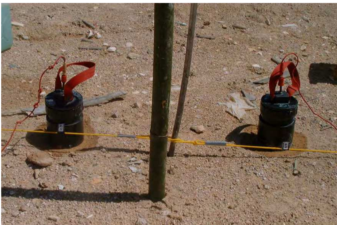
Figura 3 – Detalhe dos eletrodos não polarizáveis de potencial.
