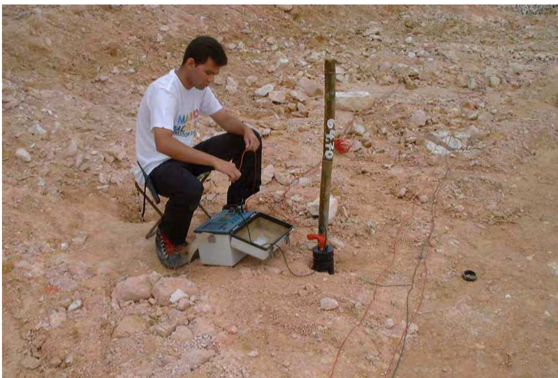
Figura 1 – Detalhe do receptor e do eletrodo de potencial no arranjo dipolo-dipolo.
