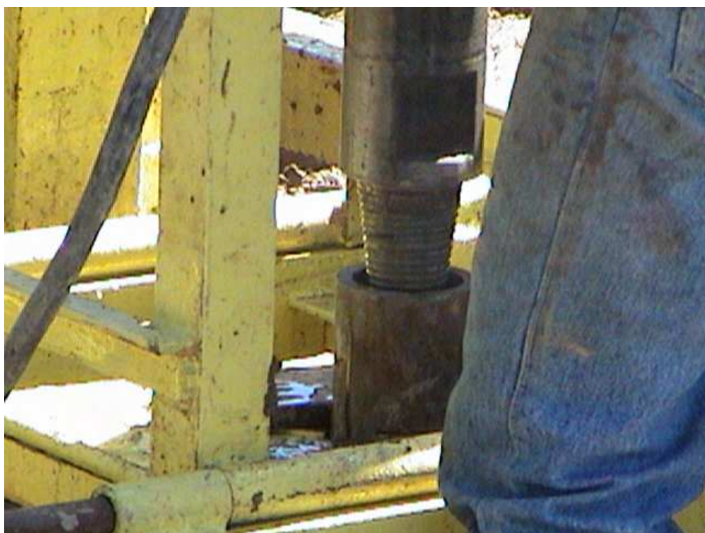
Figura 10 – Adição de haste de perfuração.
