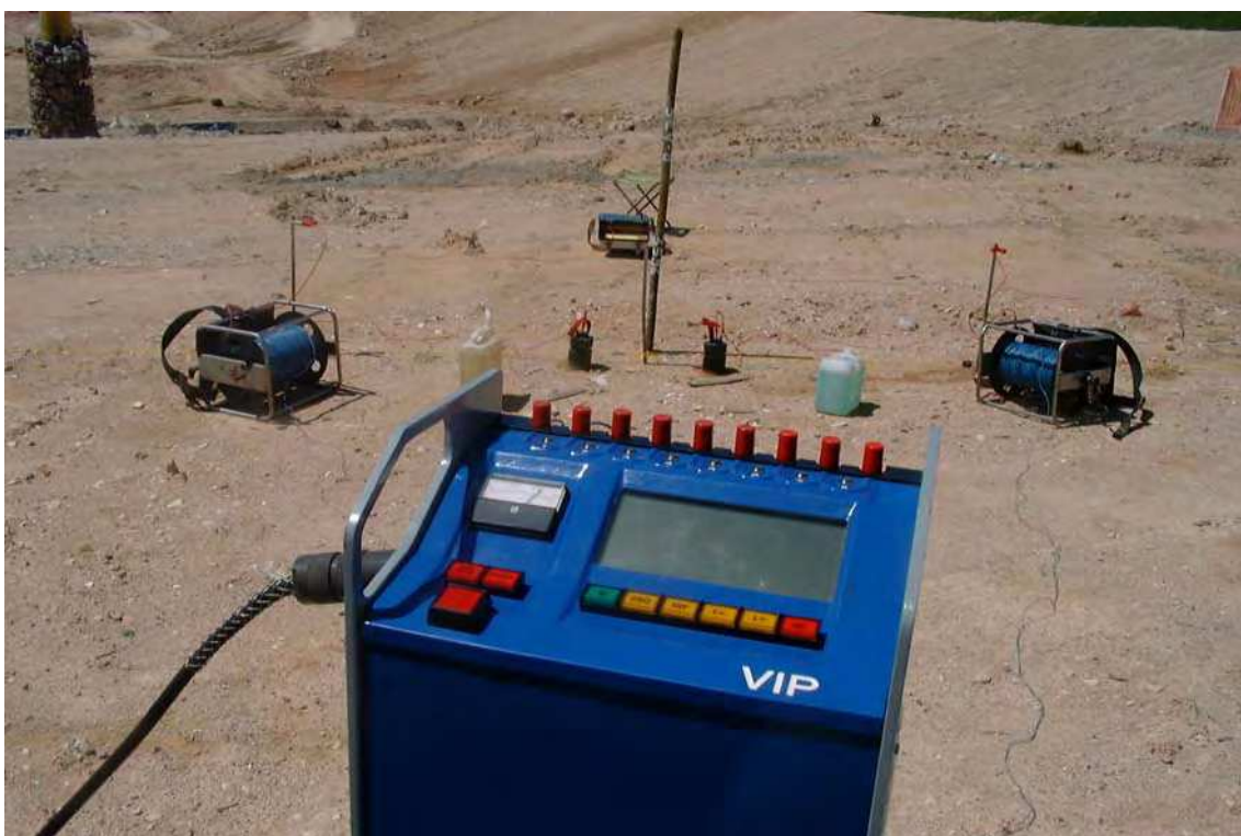
Figura 5 – Transmissor de corrente (primeiro plano) e disposição do arranjo Schlumberger.
