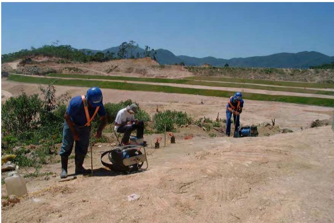
Figura 4 – Operação de uma sondagem elétrica vertical (SEV) com o arranjo Schlumberger.
