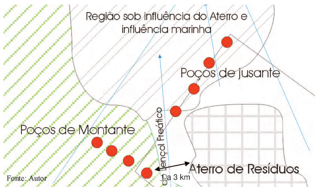
Figura 8 – Localização dos poços de monitoramento. Situação sem escala.
