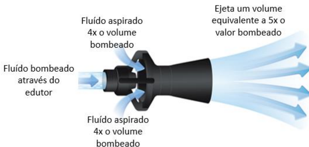
Figura 8 – Sistema de agitação por bicos indutores
