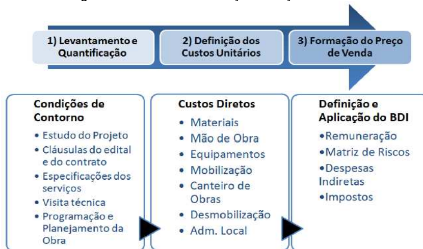
Figura 13 – Processo de orçamentação de obras
