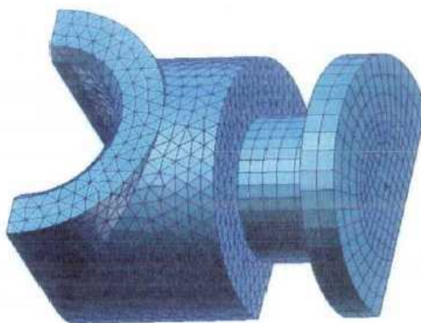
Figura 6.8 Análise dos retentores do levantador de rodas (macaco) em Zamac 5 (Peça mapeada e sem nenhum tipo de esforço de tensões)
