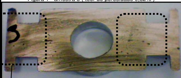
Figura 1 - amostra 3 ( teor de porosidade 0,82% )
