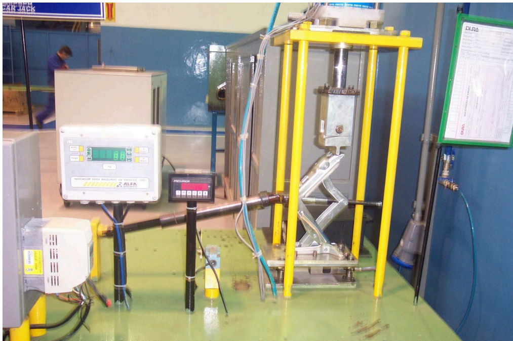
Figura 3.3 Ensaio de Durabilidade com Mancal de Zamac Fonte: Engeteste (2007)
