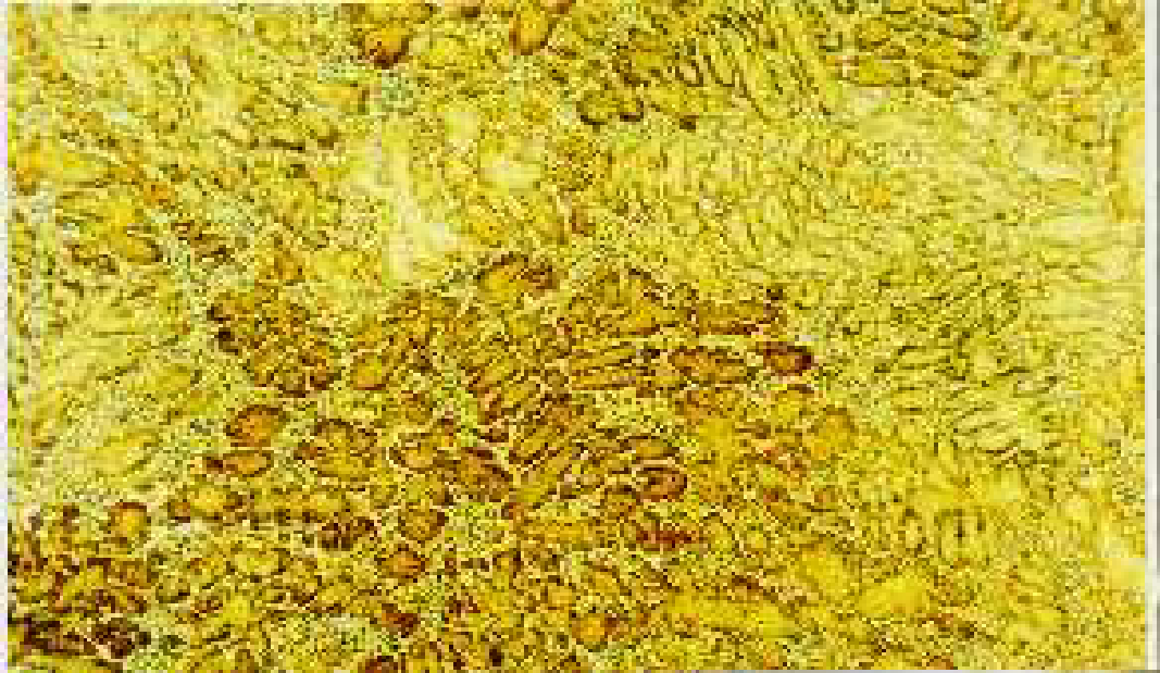
Figura 4.5 Foto micrográfica da microestrutura de liga Zamac (aumentada 100X) Fonte: Votorantim (2007)
