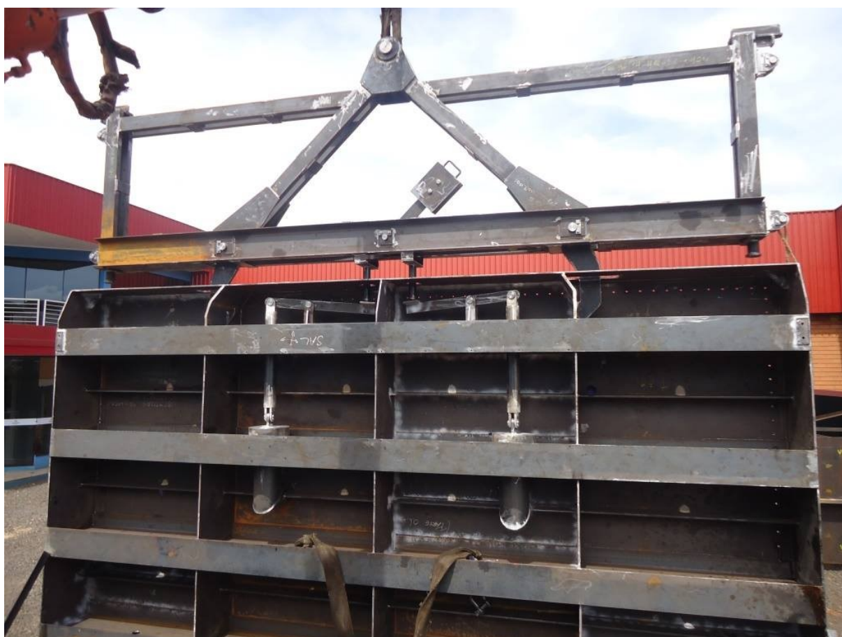
Figura 9 – Painel de comporta ensecadeira com by-pass sendo operado pela viga pescadora.
