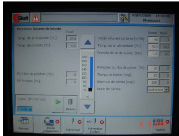
Figura 3.23 - Painel de comando do leito fluidizado.
