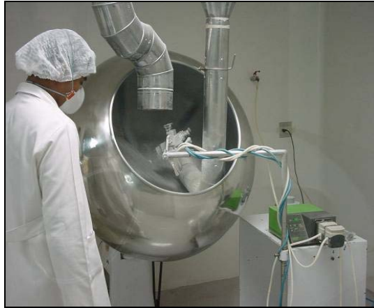
Figura 2.8 - Instalação típica de drageadeira convencional (PALACIOS, 2009).
