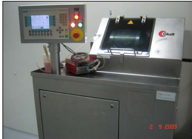
Figura 3.2 - Revestidora Glatt - modelo GC 300.1.
