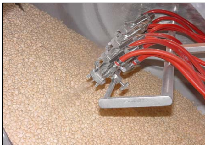
Figura 2.9 - Posicionamento dos bicos aspersores dentro do tambor (SANTIAGO, 2009).
