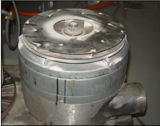
Figura 3.18 - Turbina desmontada para limpeza.
