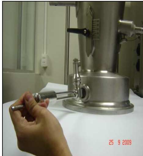
Figura 3.14 - Local da inserção do bico aspersor para o sistema bottom spray .
