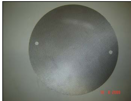
Figura 3.9 - Tela de retenção com diâmetro 230 mm.
