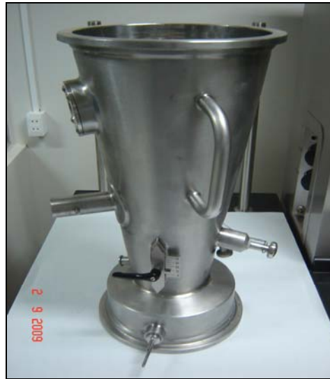
Figura 3.12 - Câmara de expansão para o sistema bottom spray .
