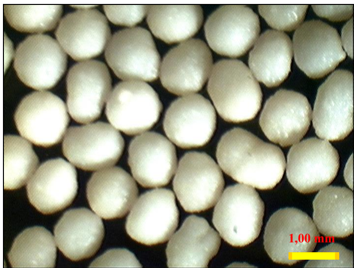
Figura 4.2 - Micrografia dos péletes com princípio ativo anlodipino 5%.
