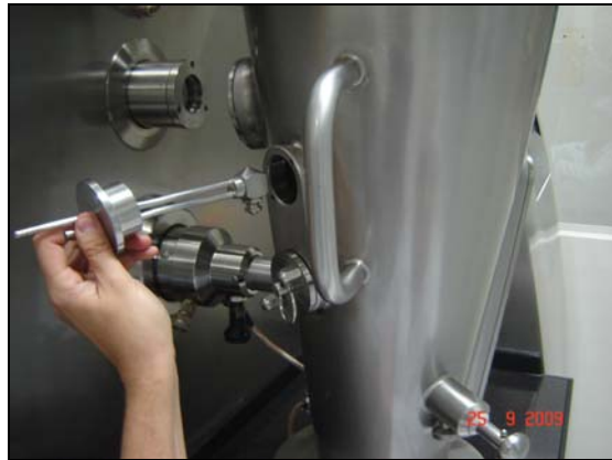
Figura 3.10 - Local da inserção do bico aspersor para o sistema top spray .
