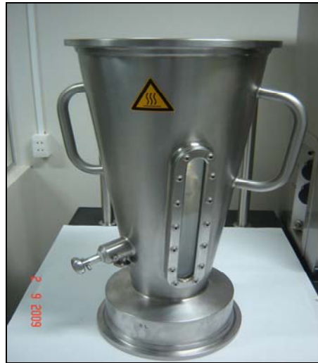
Figura 3.8 - Câmara de expansão para o sistema top spray .
