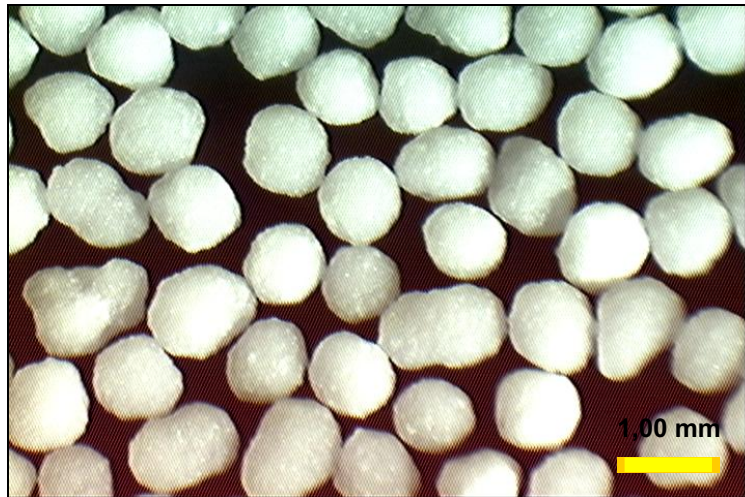
Figura 3.24 - Micrografia dos péletes inertes utilizados nos experimentos.
