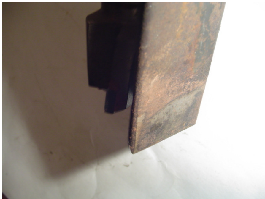
Figura 36 - Calha de aço SAE 6150 e fresa de Metal Duro
