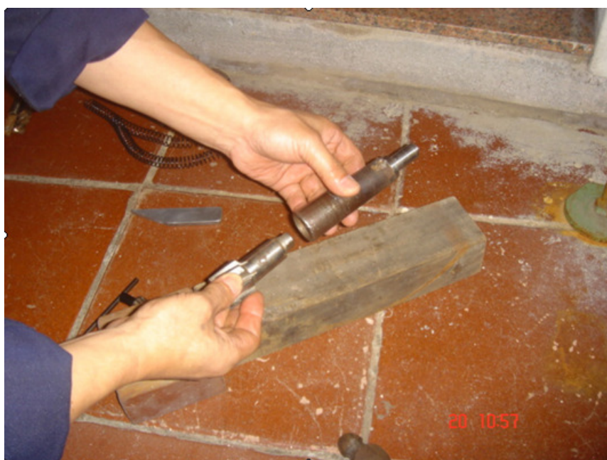
Figura 33 - Montagem da fresa
