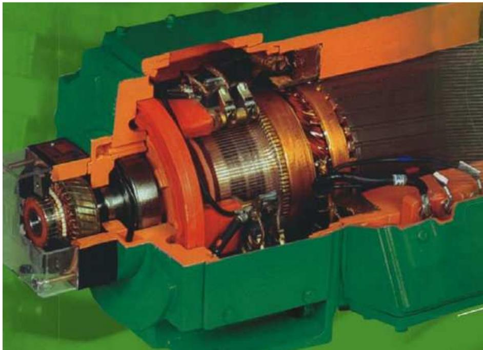
Figura 1 - Motor de corrente contínua em corte (INO, 2010).
