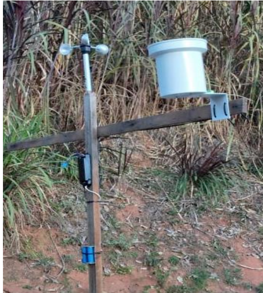
Figura 2 – Montagem do protótipo desenvolvido da estação meteorológica
