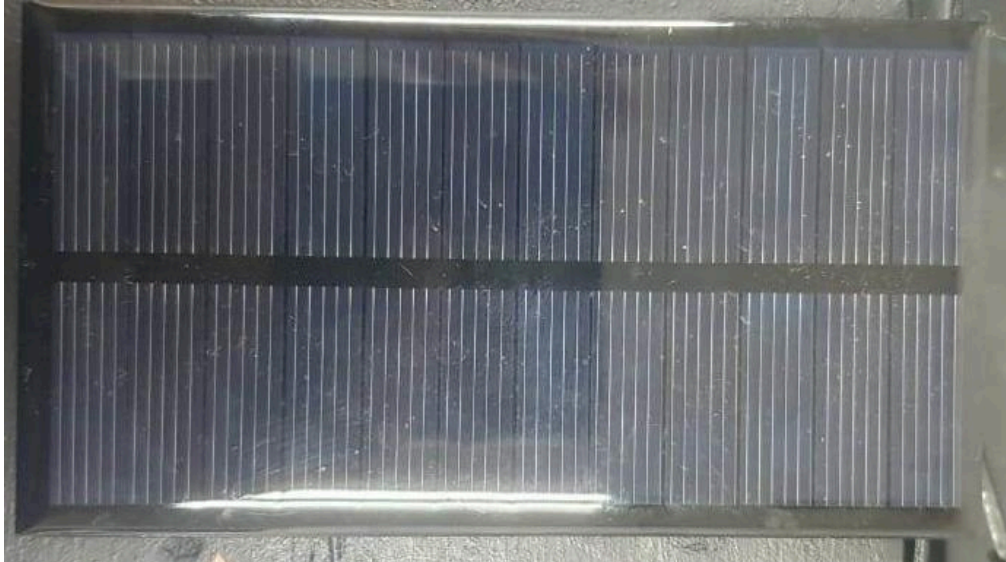
Figura 26 – Painel solar fotovoltaico
