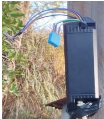
Figura 3 – Central que armazena a comunicação dos sensores com o ESP8266
