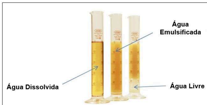
Figura 2 - Formas da água no diesel. Fonte: (LOBO, 2019).
