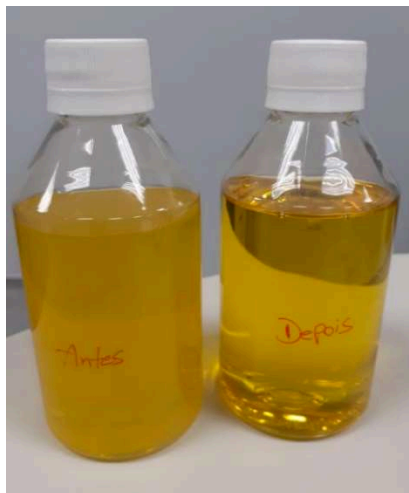
Figura 42 - Diesel antes e depois da passagem pelo filtro na bancada de testes. Fonte: (Autor).
