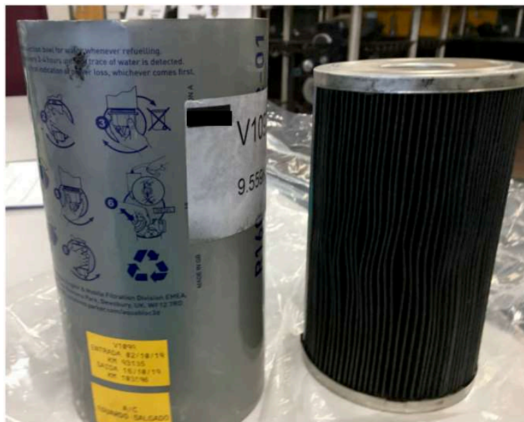
Figura 48 - Aspecto visual do meio filtrante após teste de rodagem de 9.559 km (Lote C). Fonte: (Autor).
