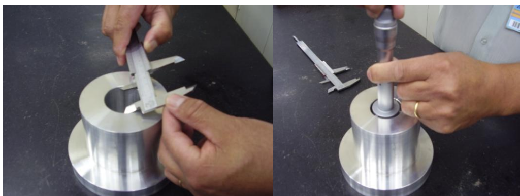
FIGURA 4.3- Medida de diâmetro com paquímetro e com micrômetro interno (IAE, 2010)
