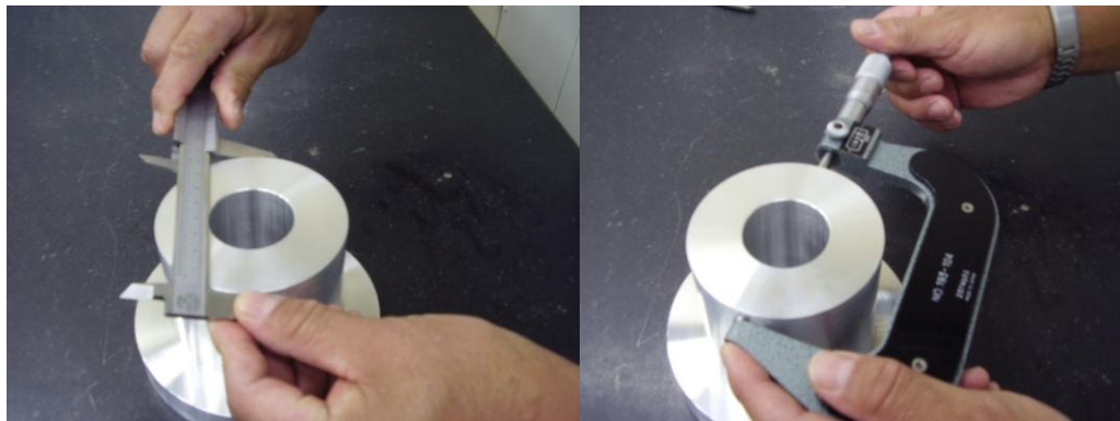
FIGURA 4.2- Medida de diâmetro com paquímetro e com micrômetro externo (IAE, 2010)
