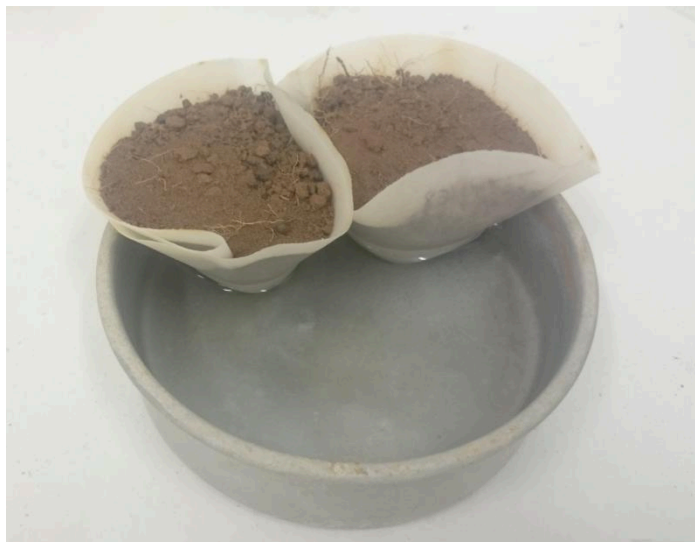
Figura 2. Funil de papel filtro contendo amostra de solo em contato com água, para umedecimento por capilaridade.
