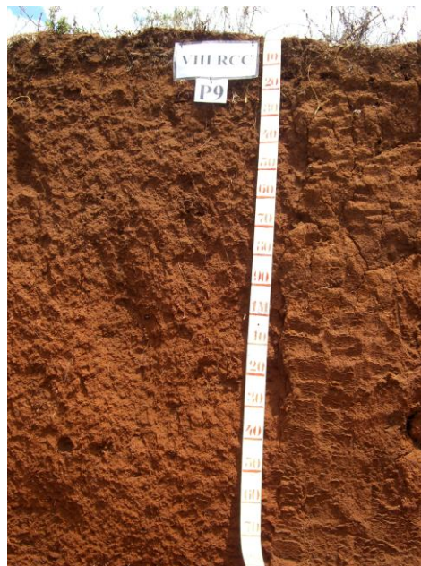
Figura 4: Perfil típico de solo latossolo vermelho. Fonte: Embrapa (2021).
