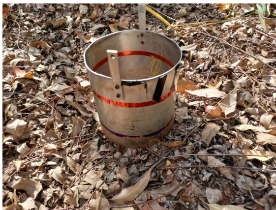
Figura 11: Infiltrômetro de anel único utilizado no teste. Fonte: Autor.
