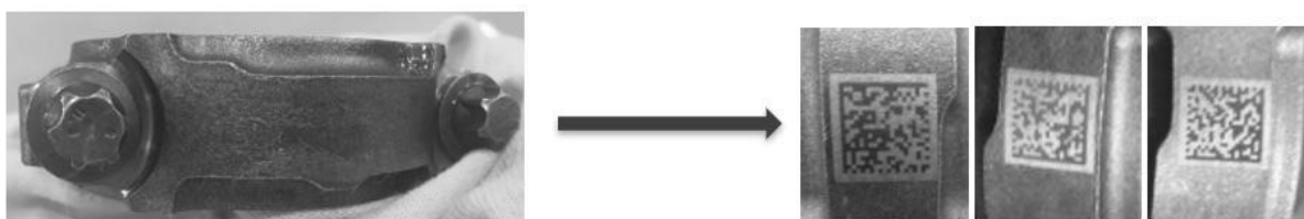
Figura 14: Processo de impressão com a peça totalmente seca
