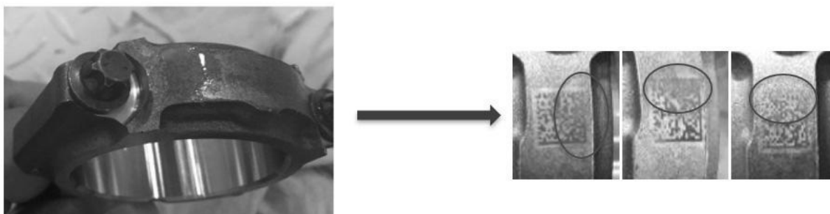
Figura 15: Processo de impressão com a peça úmida
