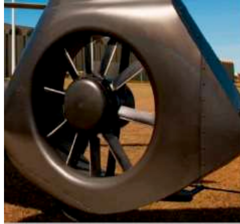
Figura 3 - Rotor Traseiro da aeronave Pantera AS365 K2 Fonte: apostila do Curso de Teoria de Habilitação à Manutenção a Aeronave AS365 K2.
