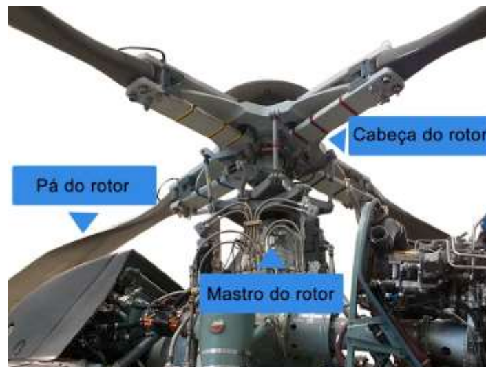
Figura 2 - Rotor Principal da aeronave Pantera AS365 K2 Fonte: Apostila do Curso de Teoria de Habilitação à Manutenção a Aeronave AS365 K2.
