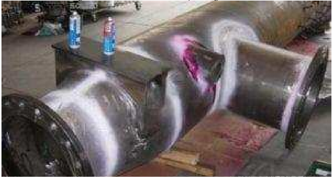
Figura 19– Ensaio de LP em Tubulação Flangeada
