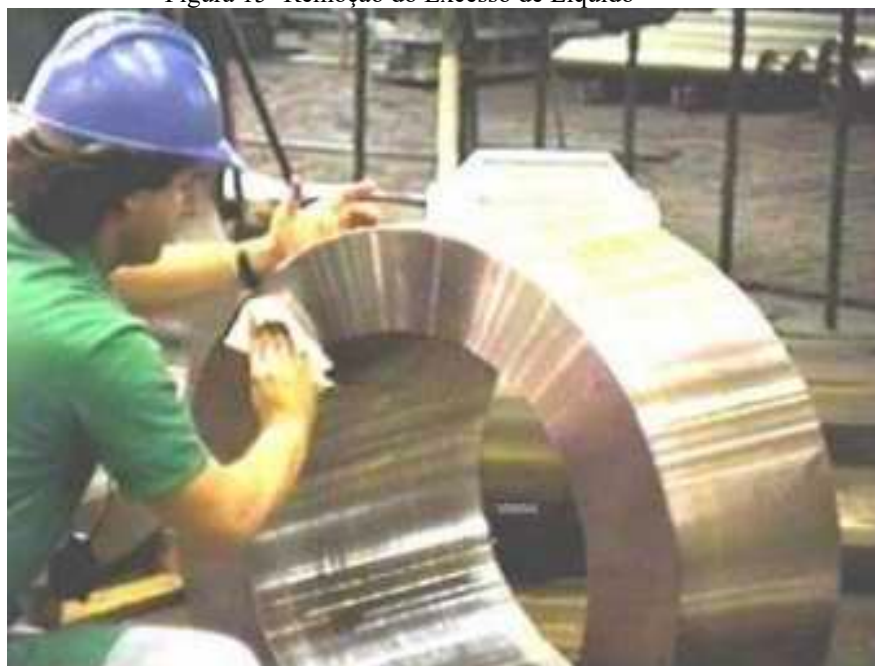
Figura 15- Remoção do Excesso de Líquido
