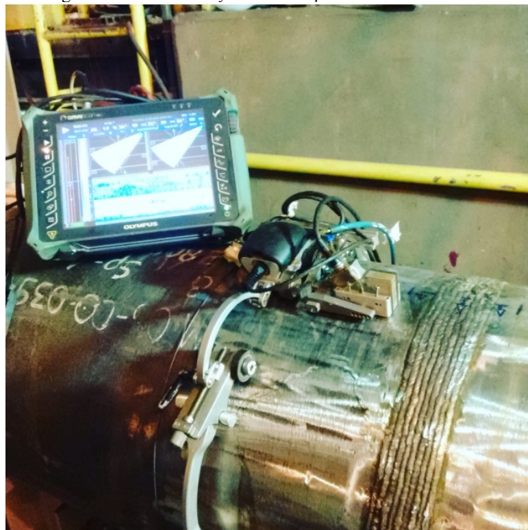
Figura 32- Phased Array em Tubulação de Processo
