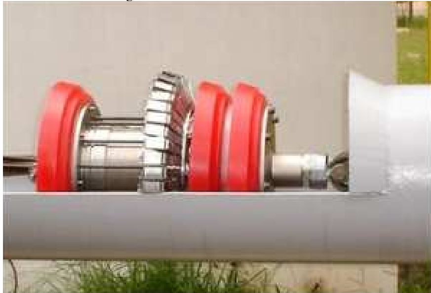
Figura 38- PIG de Corrosão 16"
