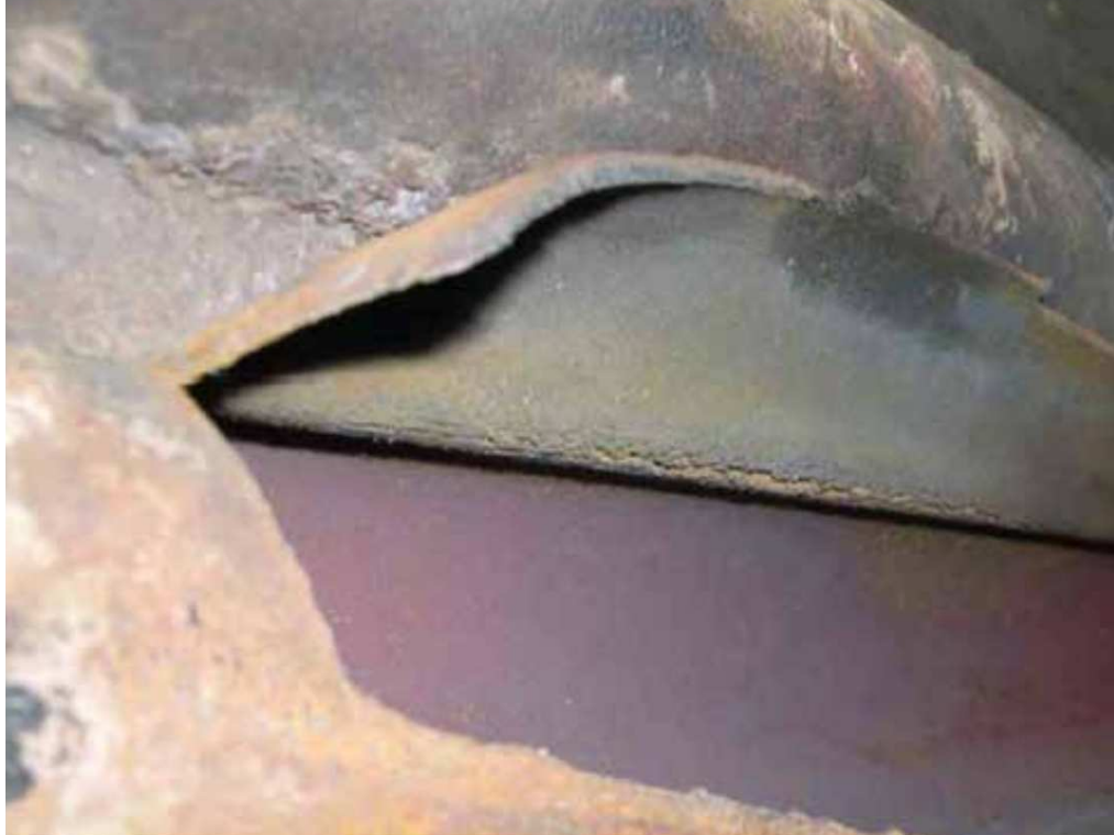
Figura 11 - Falha por Corrosão-fadiga em Tubo de Alta Temperatura e Pressão
