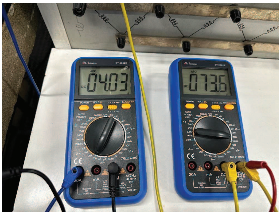
Figura 59 - Registro de leitura 07 – Testes com carga - tensão e corrente de saída (Condição 3 - Quadro 10).
