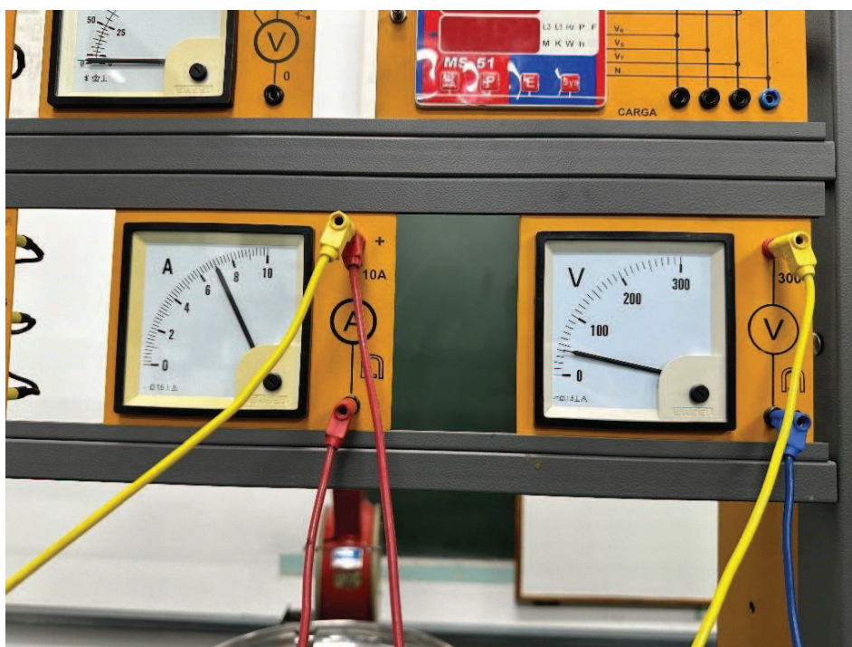
Figura 58 - Registro de leitura 06 – Testes com carga - tensão e corrente de entrada (Condição 3 - Quadro 10).
