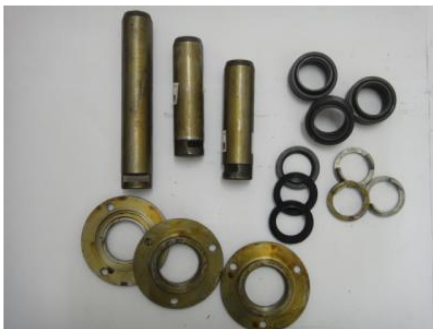
Figura 18 – Detalhe de um kit da articulação de um sistema de elevação de uma pá carregadeira (pinos, buchas e arruelas espaçadoras) Fonte – Simei (2014)
