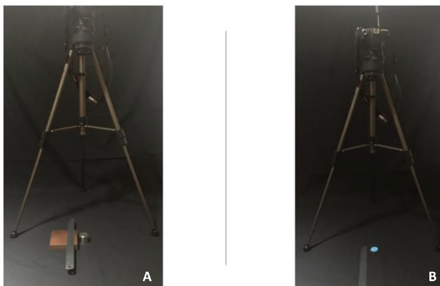
Figura 6 - Tripé utilizado para padronização da distância câmera-matriz (A) e câmera-amostra (B)
